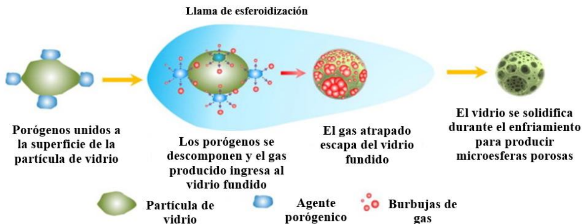
Figura 7. Mecanismo de formación de porosidad usando \text{CaCO}_3 como agente porogénico [15]
