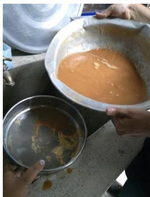
Figura 11. Ensayo de lavado sobre malla 200.
