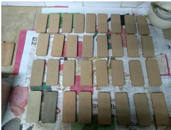
Figura 12. Probetas conformadas en verde.
