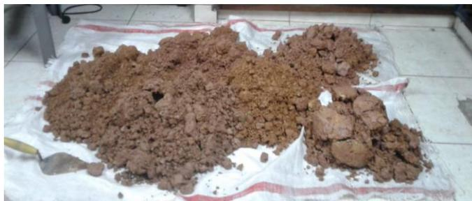
Figura 19. Secado de la muestra de Limo.
