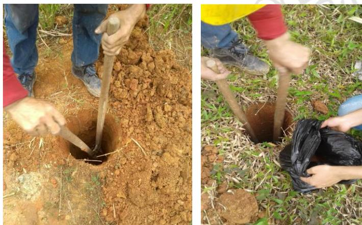
Figura 16. Extracción de las muestras de limo en la zona alta de la mina
