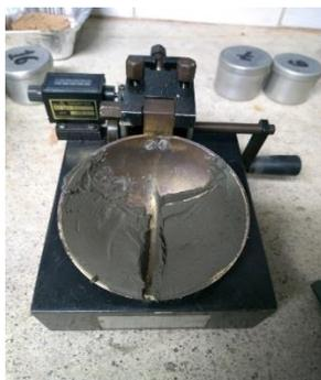
Figura 9. Cazuela de Casagrande. Realización de la prueba de Límite Líquido.
