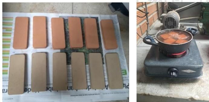
Figura 14. Ensayo de absorción
