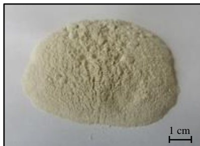
Figura 5.4. Aspecto físico de la muestra M_2 después del tratamiento térmico realizado a 600 °C por 3 horas.
