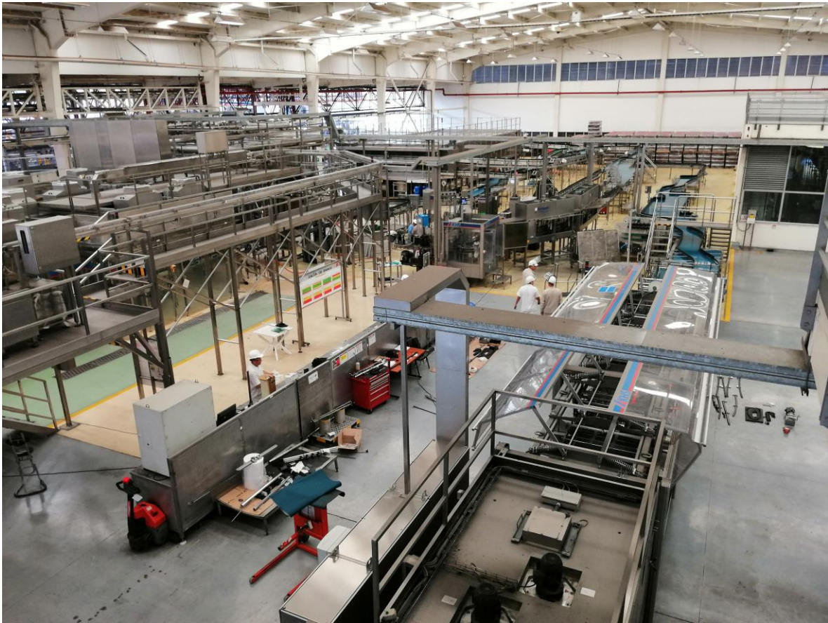
Imagen 2. Fotografía de la línea 9, línea para envasado de malta PET. Se puede observar la llenadora (izq.), pasteurizador (sup. Izq) y etiquetadora en la parte inferior de la imagen.
