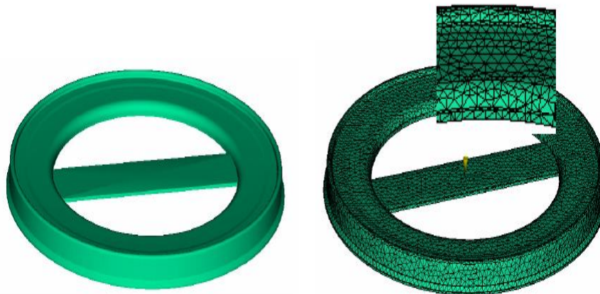
Figura 240. Modelo CAD 3D. Modelo mallado, densidad 0,02 y espesor 0.9 mm. (Gómez, 2010, p.72).
