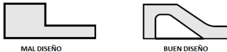
Figura 155. Diseño de paredes no uniformes vs diseño de paredes uniformes. (Campo, 2006, p.211).
