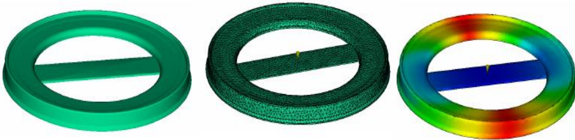
Figura 236. Modelo sólido, modelo mallado y simulación. (Gómez, 2010, p.68).
