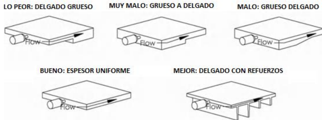
Figura 157. Diseño de espesor de pared para el flujo de material. (Kazmer, 2007, p.28).
