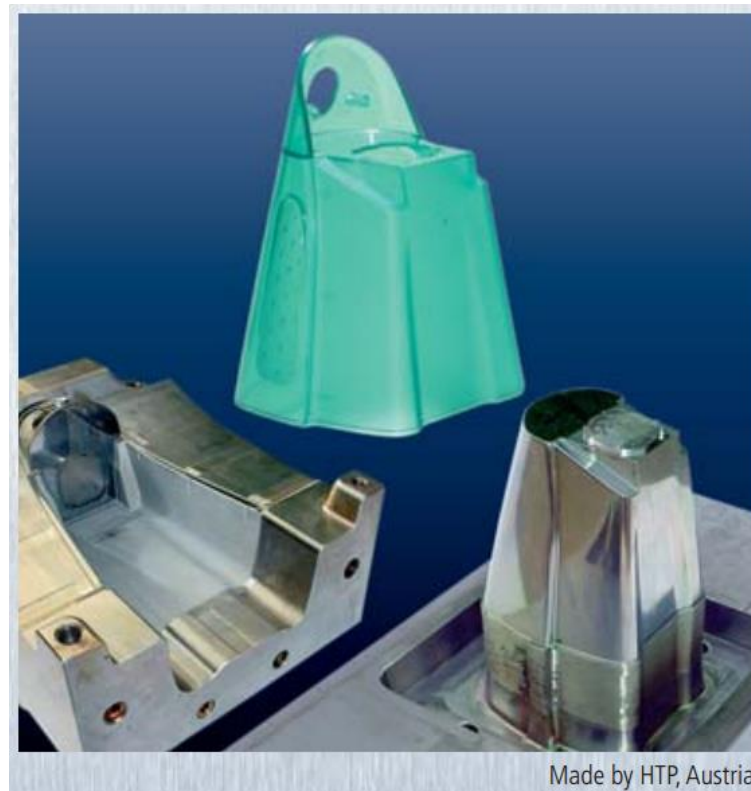
Figura 9. Cavidades de molde en aceros especiales para moldes de transformación de plástico Distribuidos por Böhler. ( Böhler , 2000, p.7).
