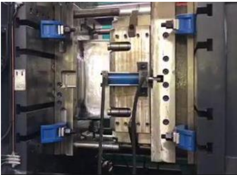
Figura 346. Diferentes tipos de bridas para fijación de molde a máquina y ejemplo de molde montado en inyectora. (Continuación). (Focus Technology Co., Ltd , 2019).
