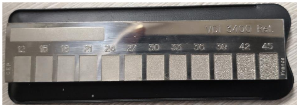
Figura 354. Fotografía de una regla de rugosidades. Elaboración propia.
