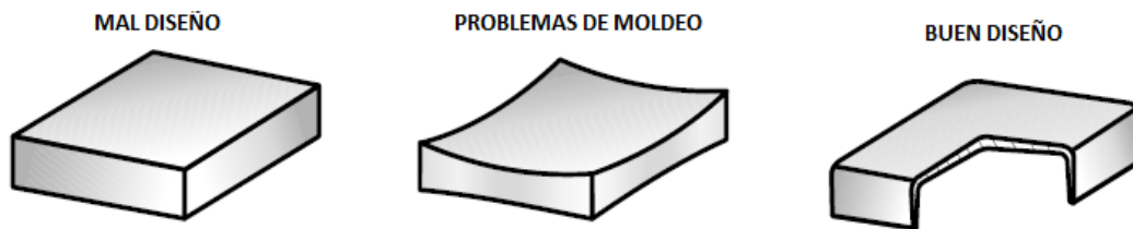
Figura 158. Diseño problemático de una bandeja rectangular. (Campo, 2006, p.212).
