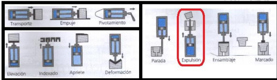
Ilustración 32. Aplicaciones de los actuadores neumáticos.
