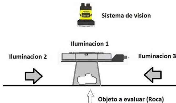
Ilustración 25. Configuración sistema de visión.
