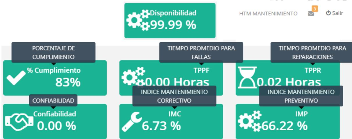
Ilustración 85. Captura de indicadores Software HTM Mantenimiento.
