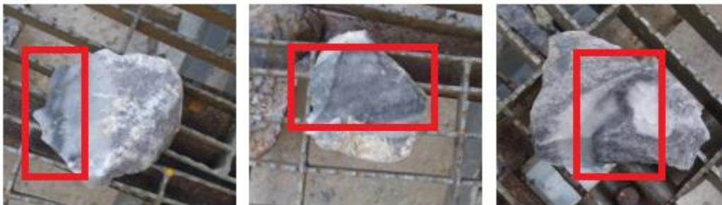
Ilustración 2. Caliza con presencia de bandas de sílice.
