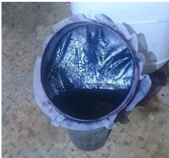
Imagen 3: filtración de agua para muestra de lodos.
