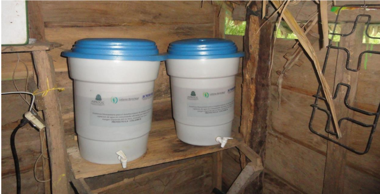
Imagen 12. Filtros cerámicos artesanales para purificar el agua. En Nuevo Reino - Lorica.
