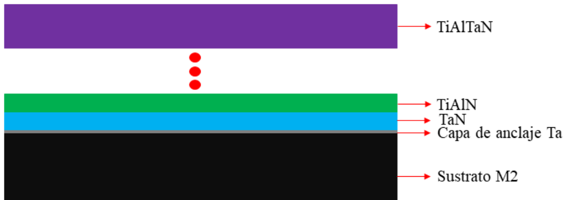
Figura 1. Representación esquemática de los recubrimientos TiAlTaN-TiAlN/TaN propuestos.
