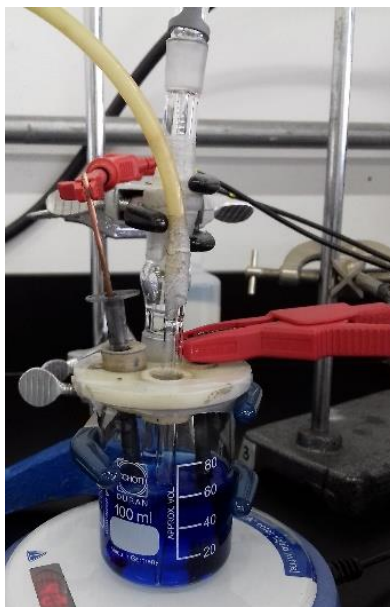
Figura 4. Celda electroquímica para ensayos con Electroodos de Pasta de Carbono (CPE)
