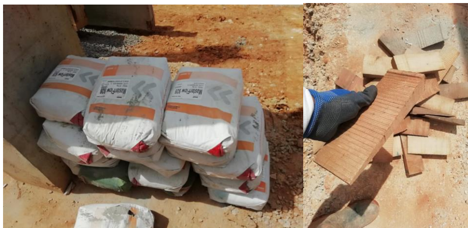
Figura 5. Fotografías de grouting Masterflow 928 y cuñas respectivamente
