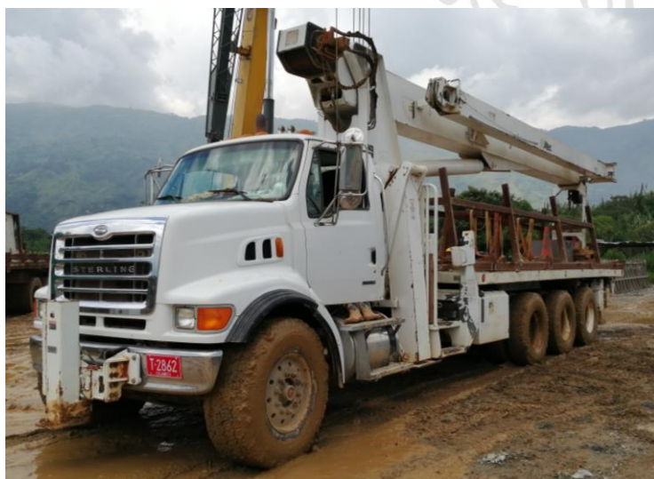
Fotografía 3. Camión de carga de prefabricados.
