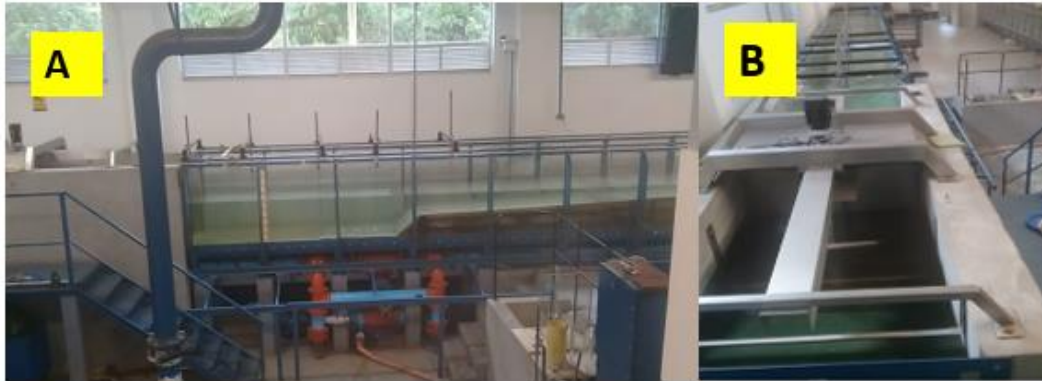
Figura 9. Ilustración del montaje del canal de olas de la Universidad Nacional de Colombia sede Medellín. A) vista longitudinal B) vista desde la parte superior del canal.
