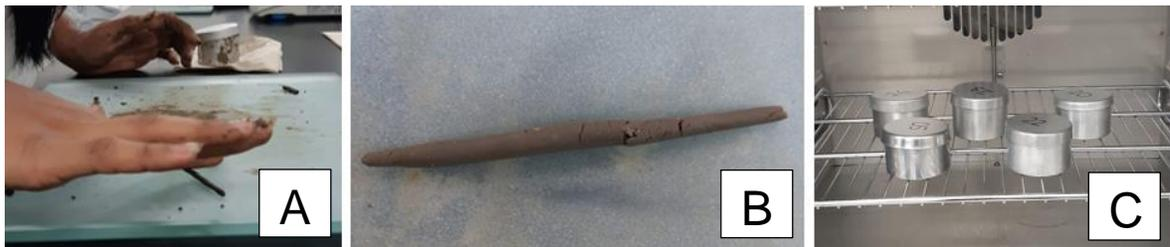
Figura 10. Procedimiento de límite plástico. A) Método manual de enrollamiento. B) Desmoronamiento. C) Secado de submuestras
