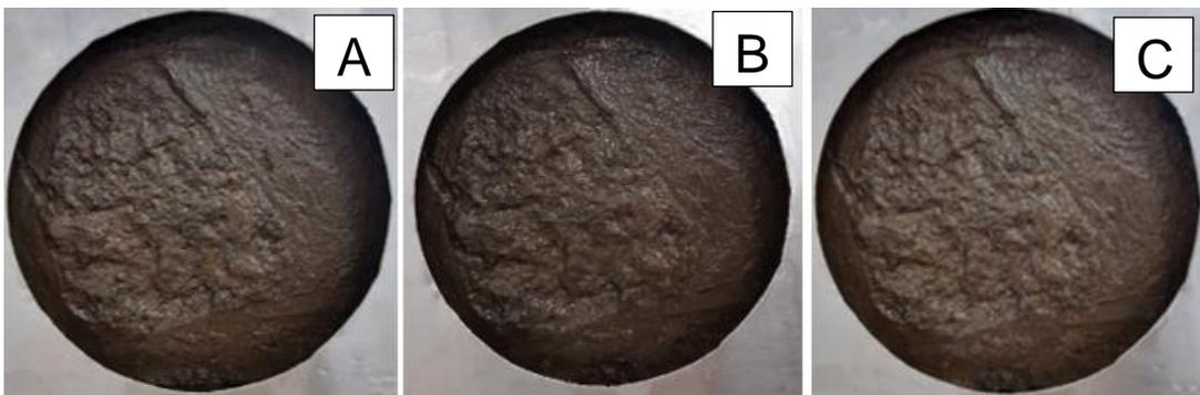
Figura 30. Desgaste del bloque 10-0-1,3-2. A) Inicio de prueba. B) 20 minutos después del inicio. C) 1 hora después del inicio
