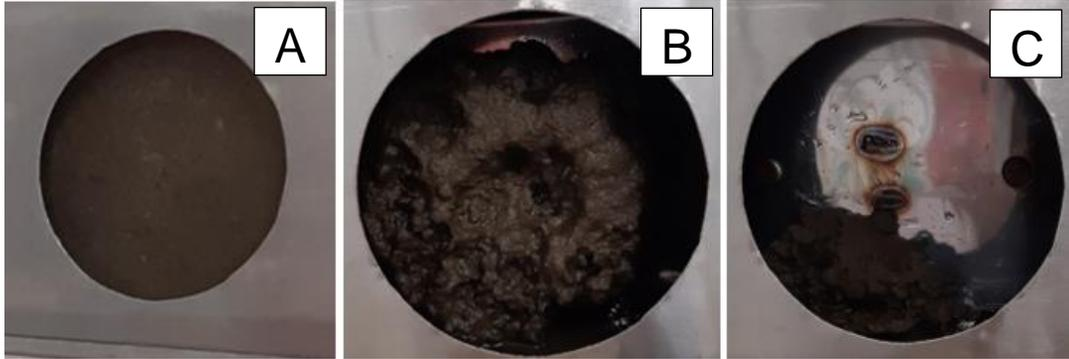
Figura 24. Desgaste del bloque 0-0-1. A) Inicio de prueba. B) 5 minutos después del inicio. C) 36 minutos después del inicio
