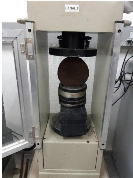
Figura 18. Montaje en el equipo de compresión
