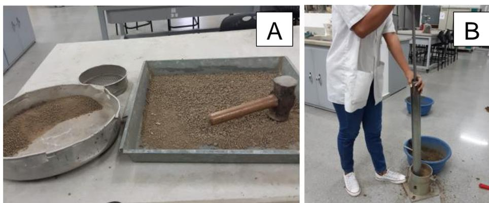
Figura 11. A) Desintegración de las agregaciones. B) Compactación
