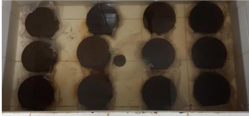
Figura 17. Bloques sumergidos en agua
