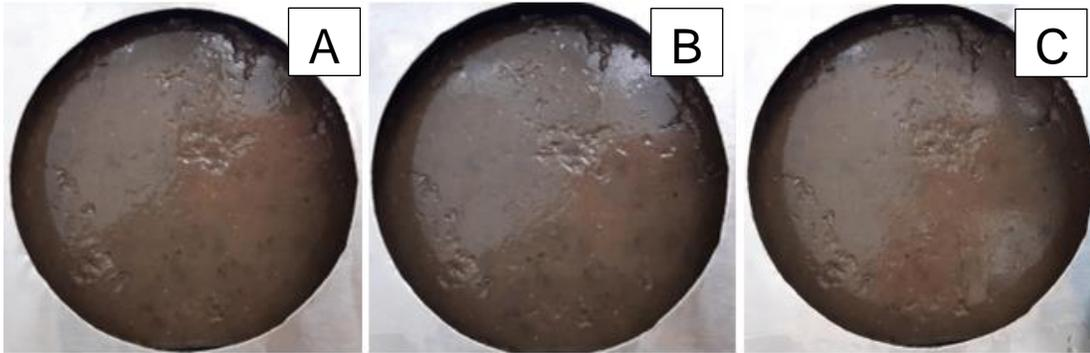
Figura 39. Desgaste del bloque 4-6-1,8-1. A) Inicio de prueba. B) 20 minutos después del inicio. C) 1 hora después del inicio
