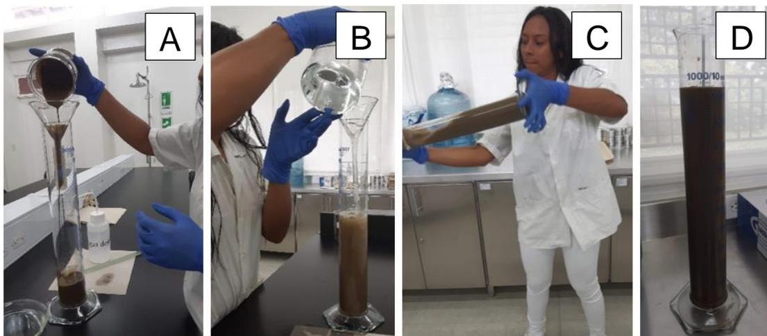
Figura 7. Preparación de muestra para iniciar lecturas con el hidrómetro. A) Transferencia de la lechada al cilindro de sedimentación. B) Adición de agua destilada hasta marca de 1000 ml. C) Agitación del cilindro. D) Muestra lista para iniciar lecturas con hidrómetro
