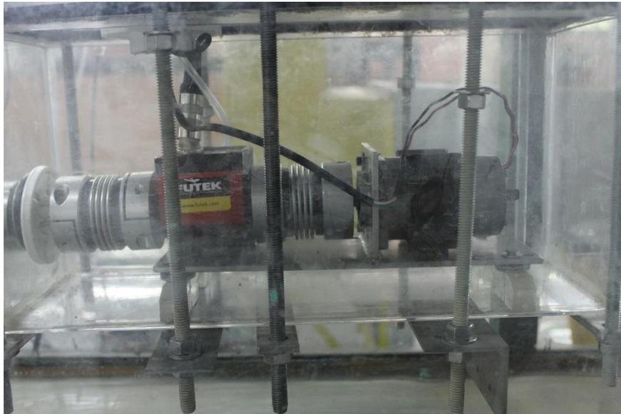
Figura 44: Modulo de adquisición de datos
