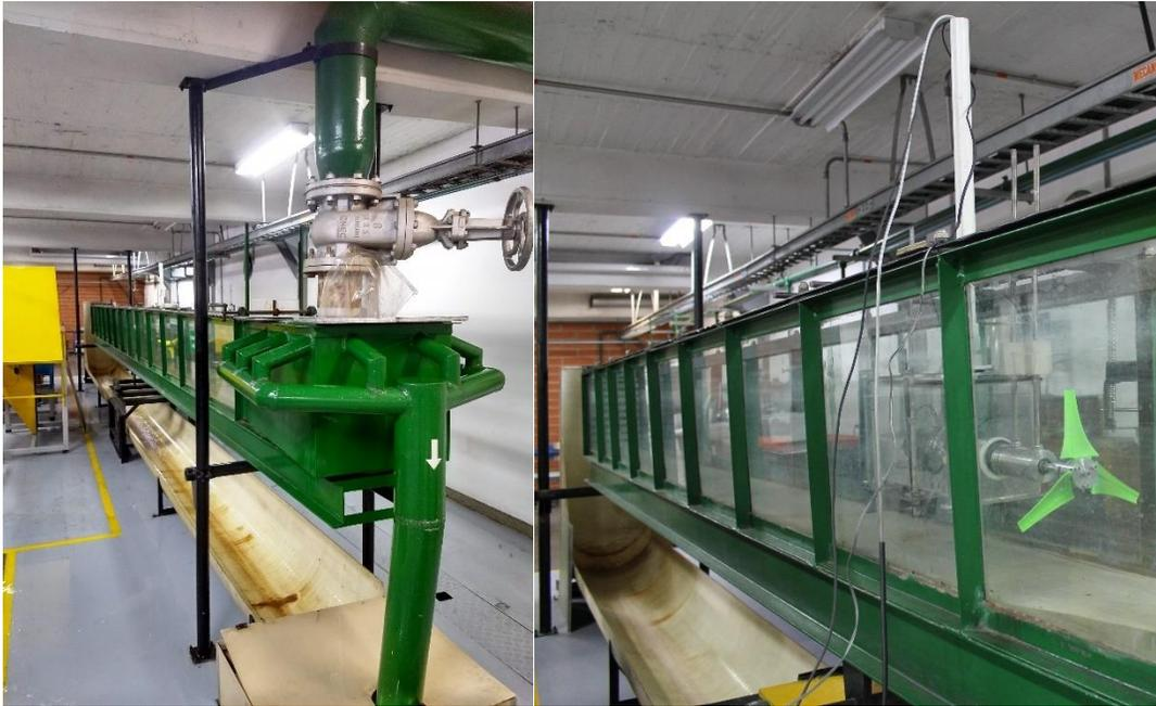
Figura 43: Canal de recirculación de agua.
