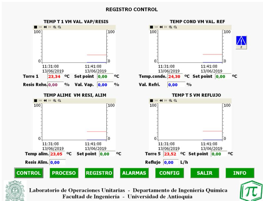
Figura 5.21. Interfaz hombre maquina SCADA (Registro-control).
