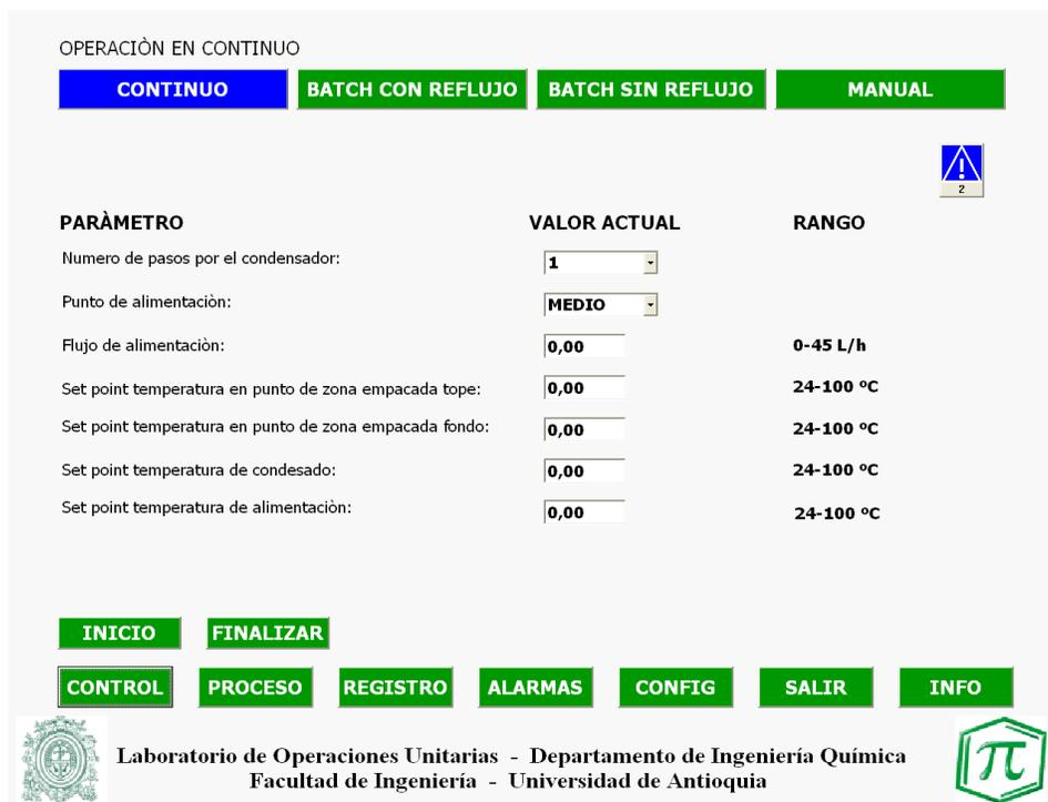
**Figura 6.4.** Interfaz hombre maquina SCADA (Control-continuo).
