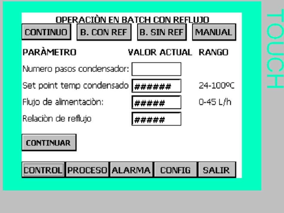
Figura 6.33. Interfaz hombre maquina panel de control (Control-batch con reflujo).
