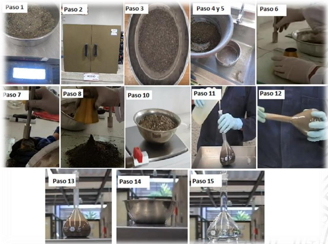
**Figura 15** Pasos para determinar la masa unitaria del agregado fino.
