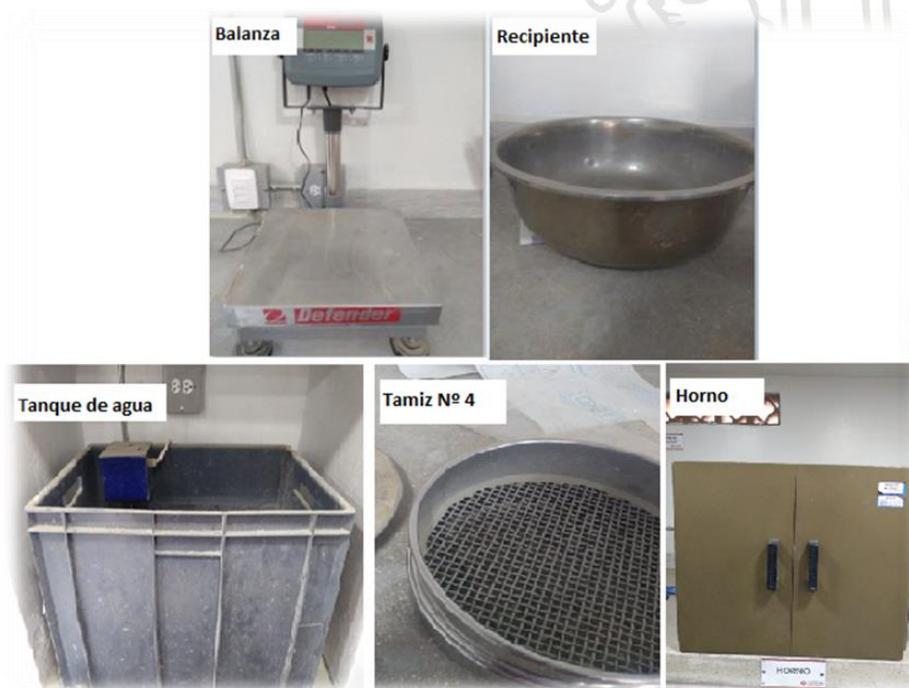
**Figura 12** Equipo necesario para hallar la masa unitaria del agregado grueso.
