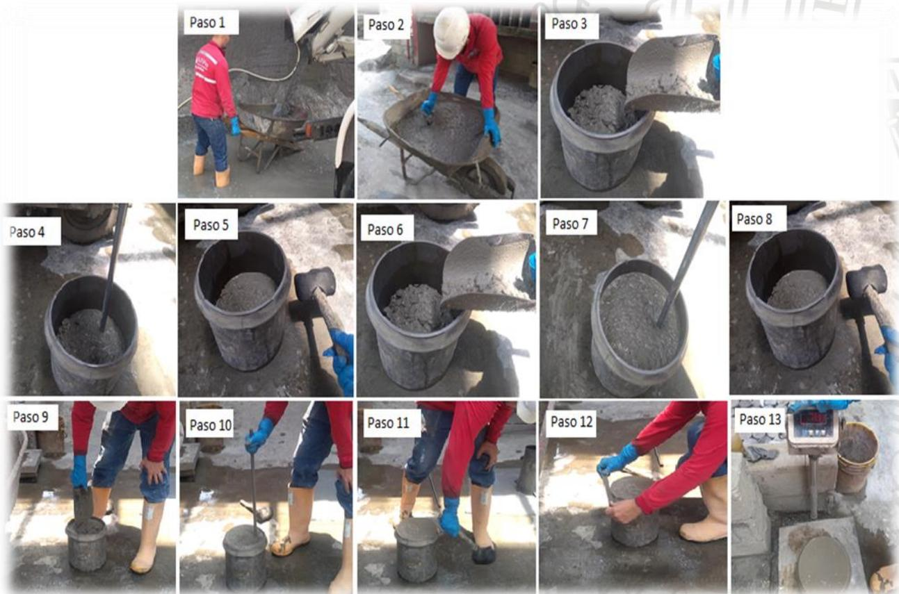
**Figura 29** Pasos necesarios para determinar la masa unitaria del concreto.
