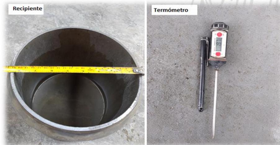
**Figura 26** Equipo necesario para tomar la temperatura del concreto en estado fresco.
