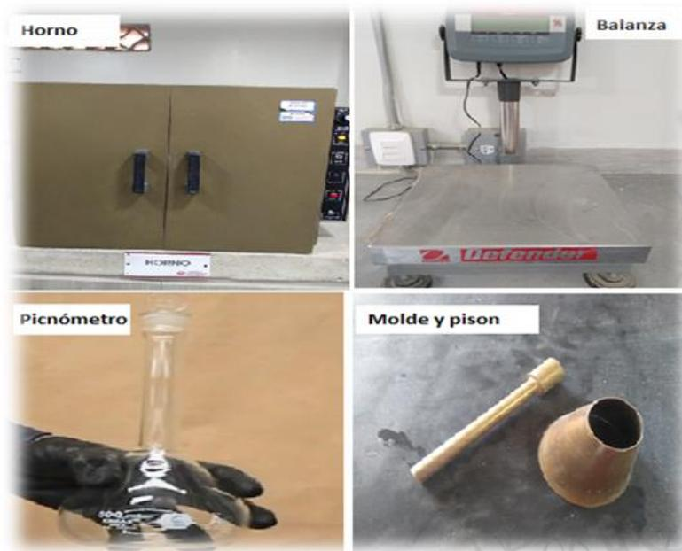
**Figura 14** Equipo necesario para determinar la masa unitaria del agregado fino.
