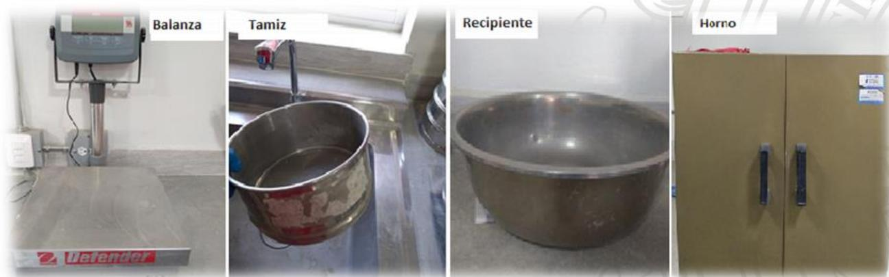
**Figura 8** Equipo necesario para determinar el material más pequeño que 75 µm por tamizado húmedo.
