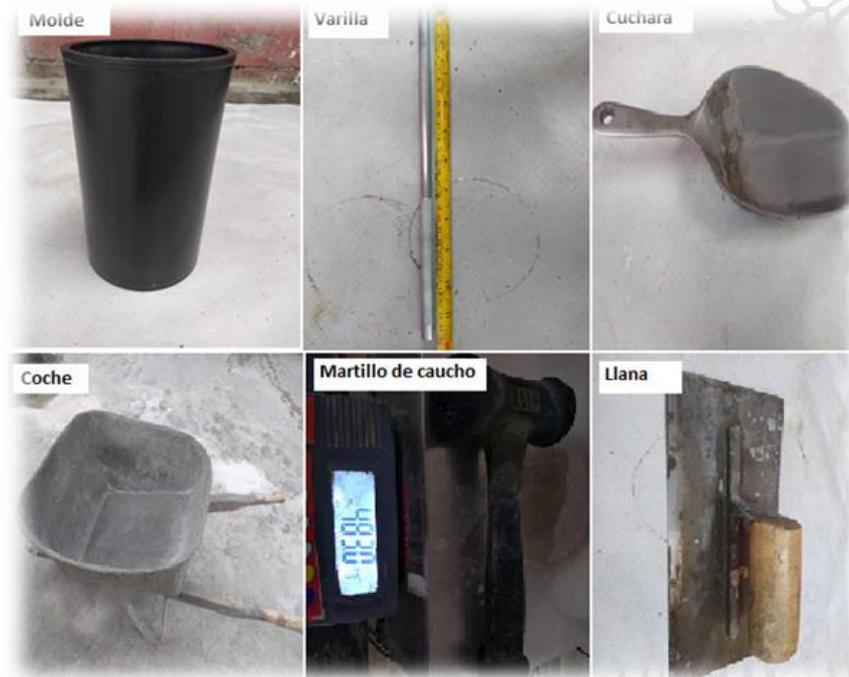
**Figura 22** Equipo necesario para realizar especímenes cilíndricos de concreto para evaluación de resistencia.
