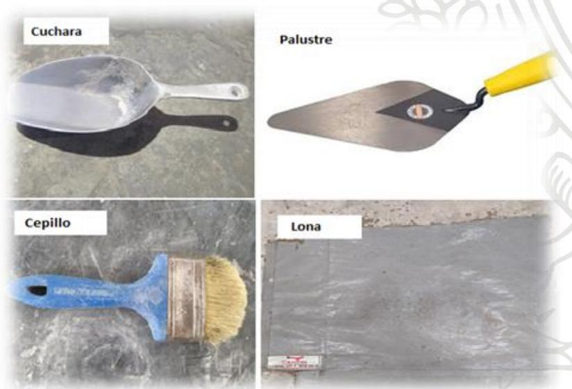
**Figura 6** Equipo necesario para la reducción de muestras de agregado
