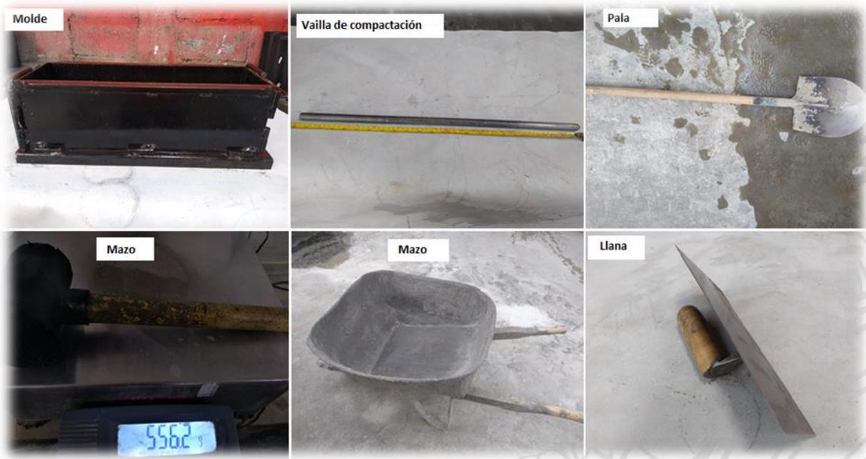
**Figura 24** Equipo necesario para realizar especímenes en forma de viga de concreto para evaluación de resistencia.
