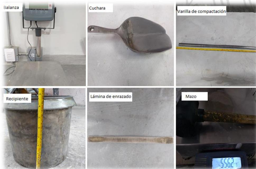
Figura 28 Equipo necesario para determinar la masa unitaria del concreto.
