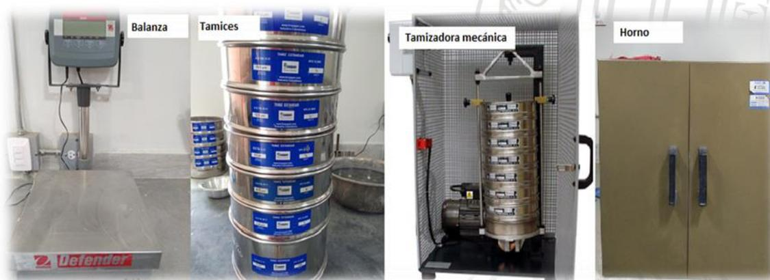
**Figura 4** Equipo necesario para el tamizado de agregados finos y gruesos.
