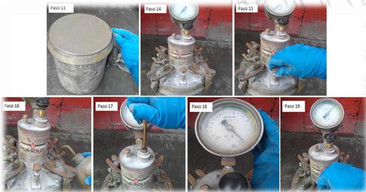
**Figura 31** Pasos necesarios para determinar el porcentaje de aire de la mezcla de concreto.
