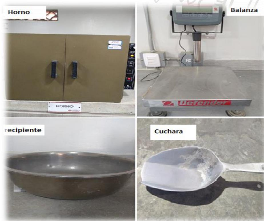
**Figura 16** Equipo necesario para hallar el porcentaje de humedad de agregados
