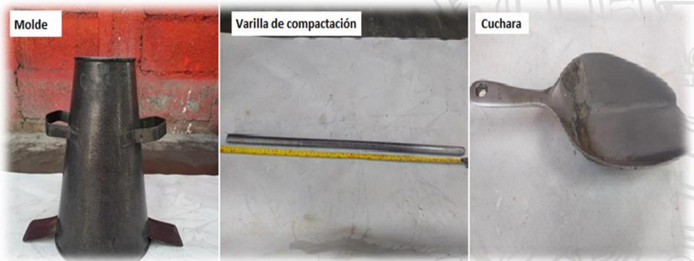
**Figura 20** Equipo necesario para realizar el asentamiento al concreto fresco.
