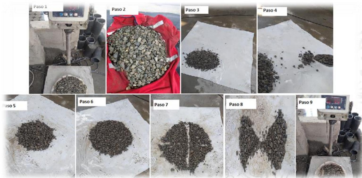
**Figura 7** Pasos para la reducción de muestras de agregados.
