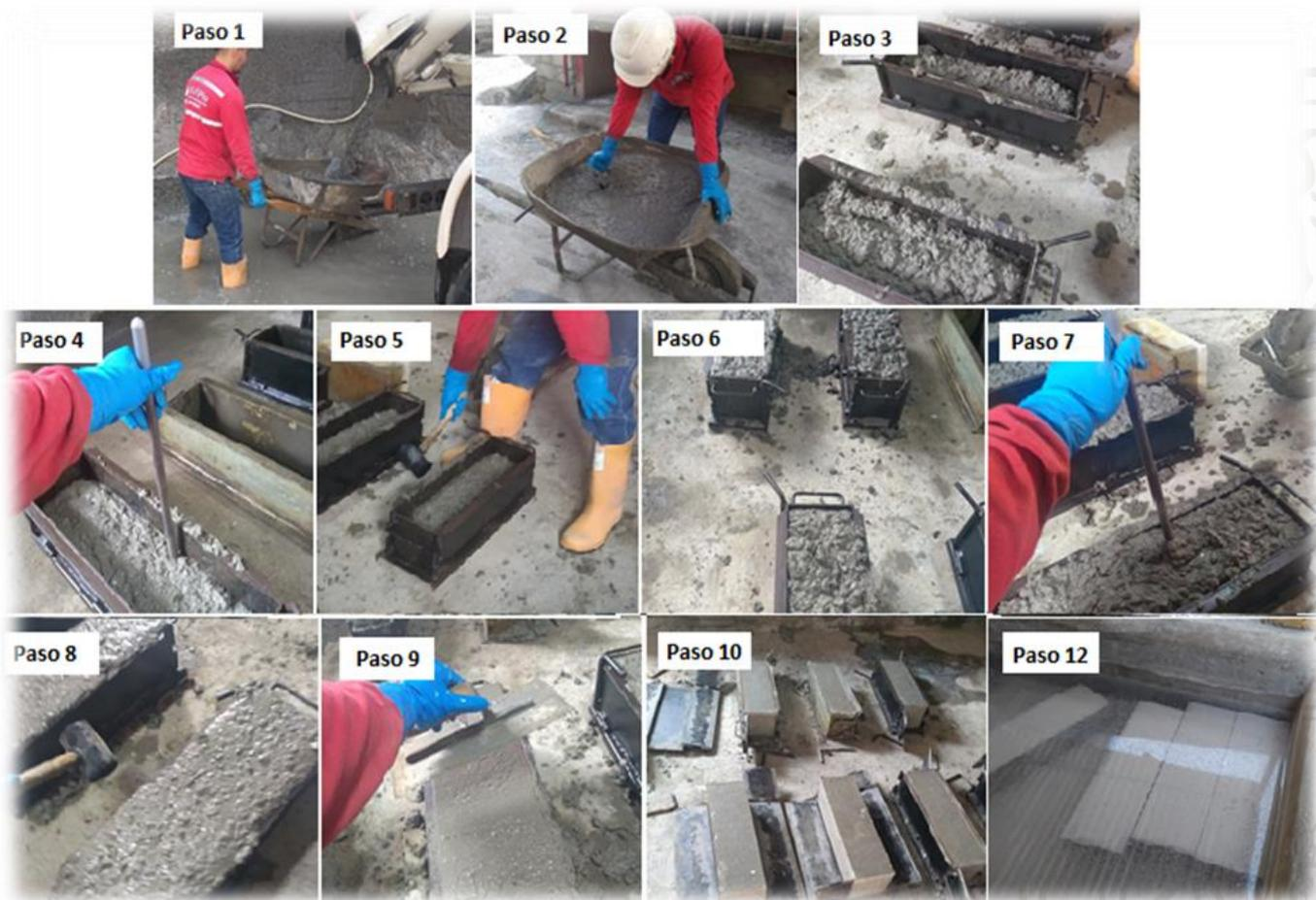
**Figura 25** Pasos para realizar especímenes en forma de viga de concreto para evaluación de resistencia.
