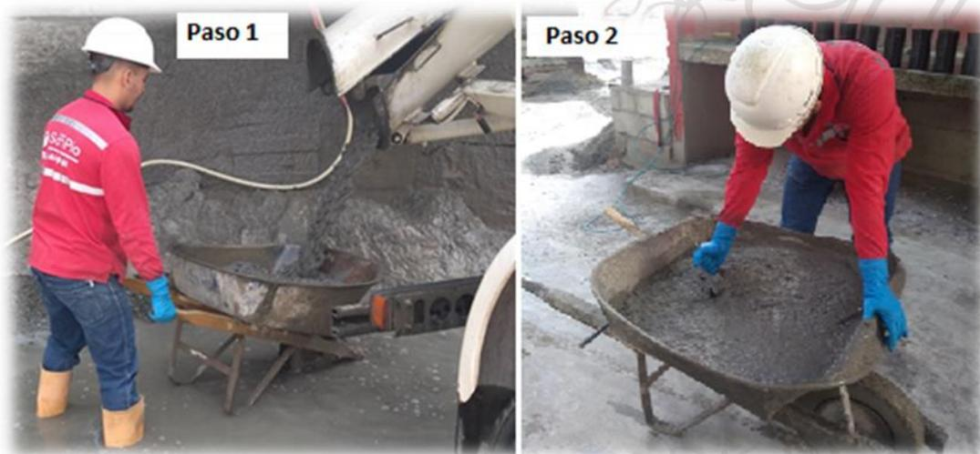
**Figura 19** Pasos para la toma de muestra de concreto fresco.
