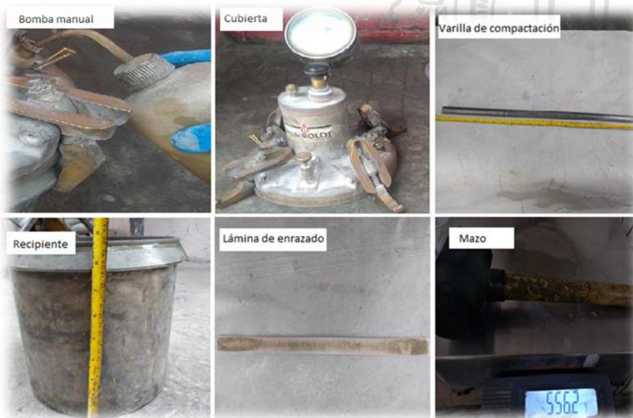
**Figura 30** Equipo necesario para determinar el porcentaje de aire de la mezcla de concreto.
