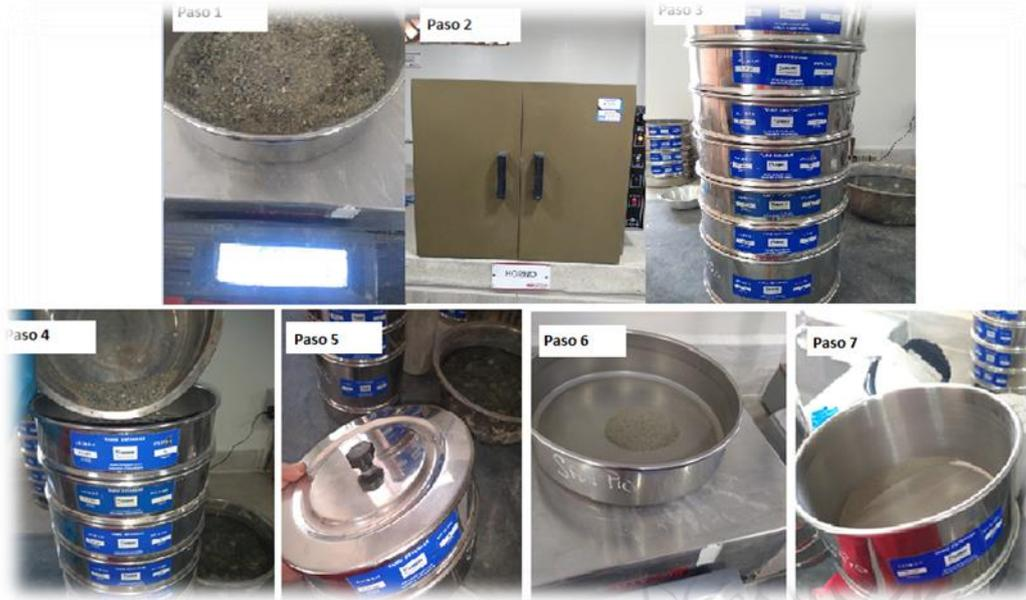
**Figura 5** Pasos para el tamizado de agregados finos y gruesos.
