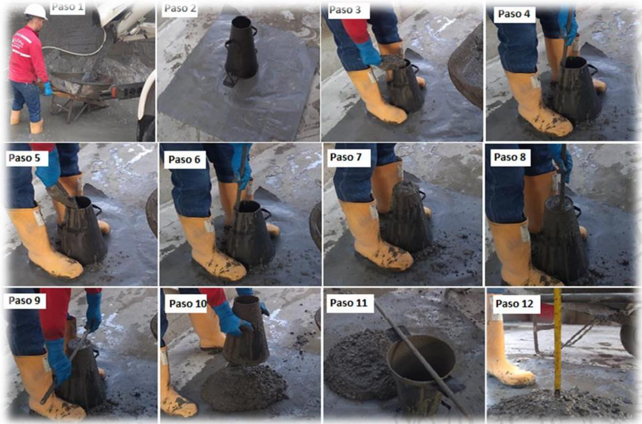
**Figura 21** Pasos para realizar el asentamiento al concreto fresco.
