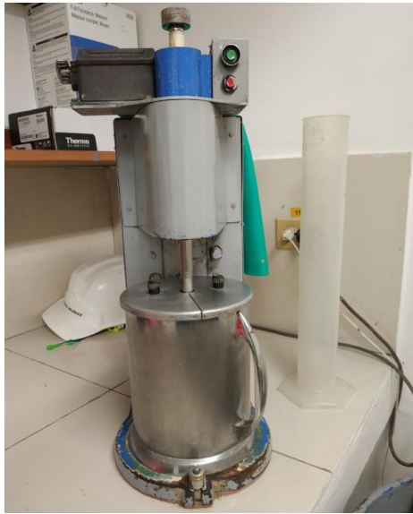
Figura 4. Desintegrador de hojas.
