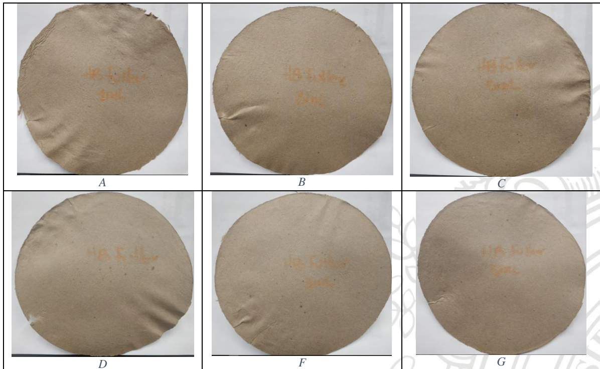
Figura 11. Dosificación de Resina adhesiva, A-1 ml plancha, B- 3ml plancha, C- 5 ml plancha, D-1 ml estufa, E-3 ml estufa. F- 5 ml estufa.
