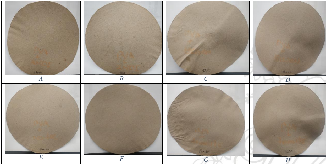
Figura 14. Combinación de dosificación de PVA+ sustancias químicas, A-antiespumante plancha, B. antiespumante estufa, C- biosida plancha, D- biosida estufa, E- antistickies plancha, F- antistickies estufa, G- floculante plancha, H-Floculante estufa.
