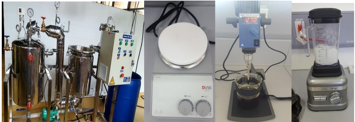
Figura 9 . Equipos utilizados en la elaboración del prototipo de shampoo plantas silvestres De izquierda a derecha (destilador por arrastre con vapor, plancha de calentamiento y agitación, agitador mecánico, licuadora)
