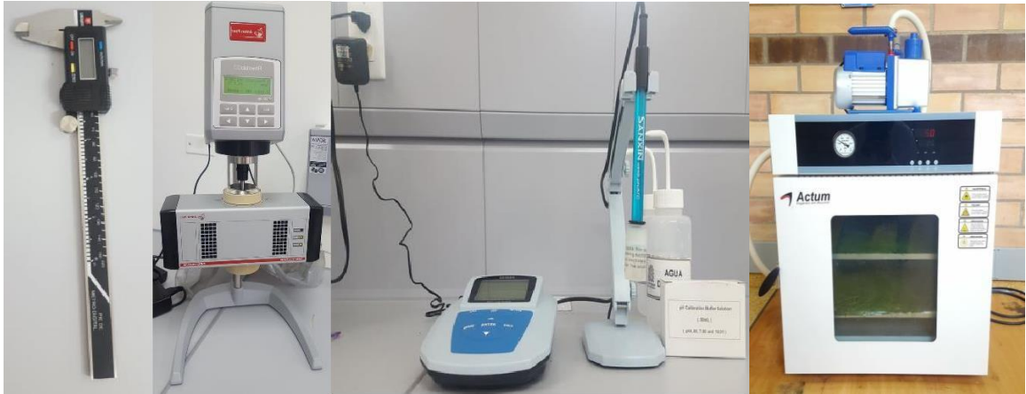
Figura 8. Equipos utilizados en la elaboración del prototipo de shampoo plantas silvestres De izquierda a derecha (pie de rey, reómetro, Ph-metro, secador al vacío)
