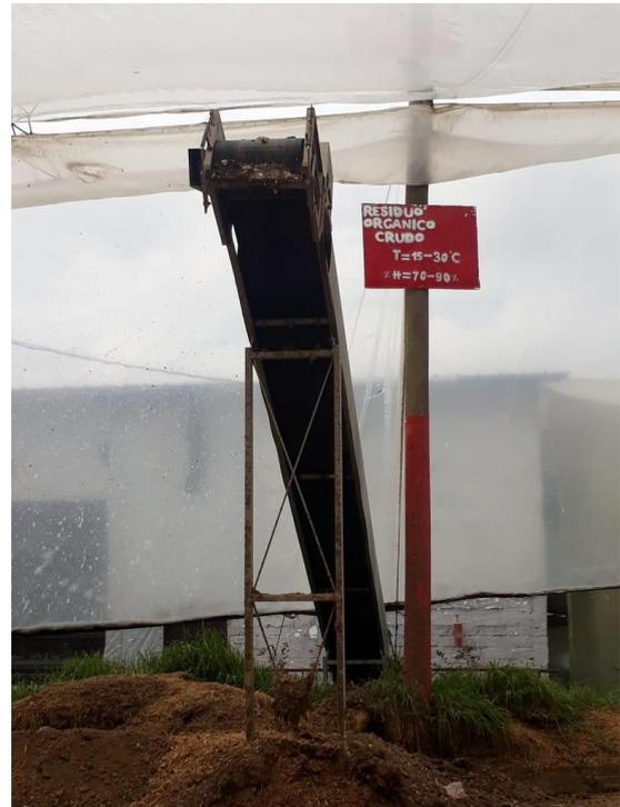
**Figura 5.1.3.1. (a)** Coches empleados para la recolección de materia orgánica de los galpones tradicionales. **(b.)** Banda transportadora de materia orgánica de los galpones automáticos hasta el invernadero de sanitización.
