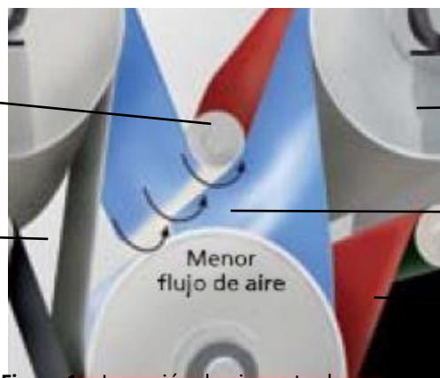
Figura 1a. Inyección de aire entre los secadores
