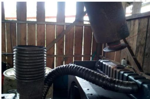
**Figura 21.** Escape del motor y ventilación.
