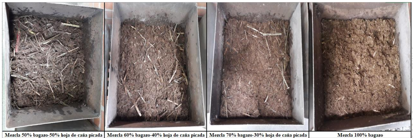
Figura 3. Mezclas bagazo-hoja de caña picada, saturadas.
