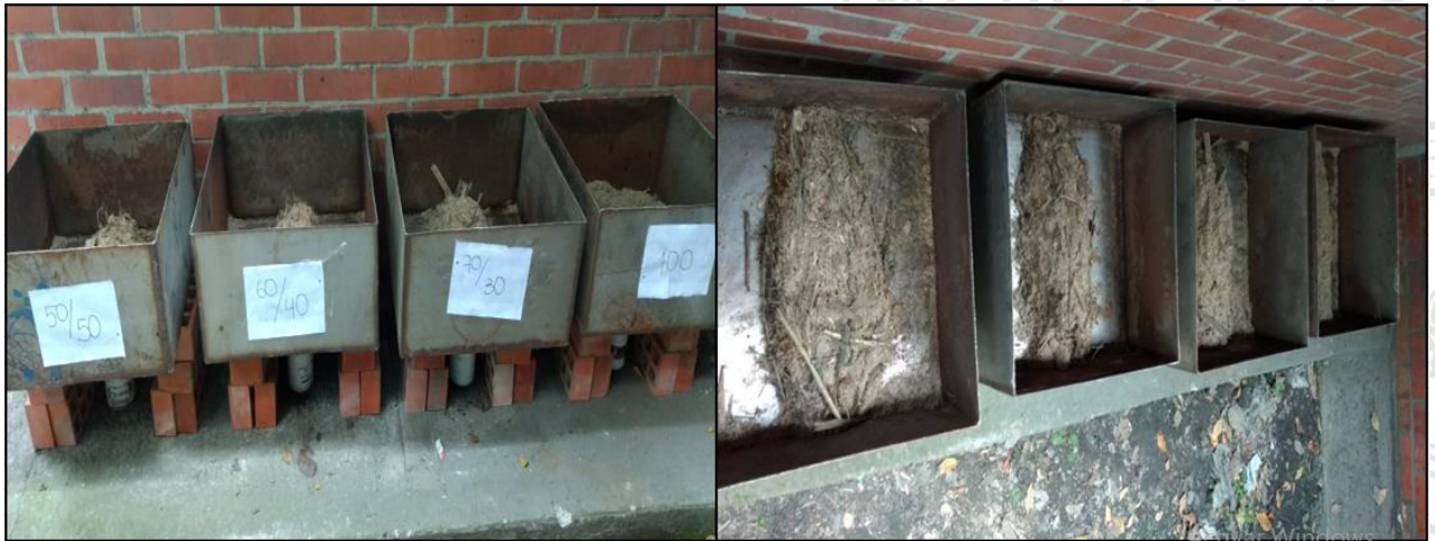
Figura 2. Montaje experimental y mezclas bagazo-hoja de caña picada a diferentes proporciones
