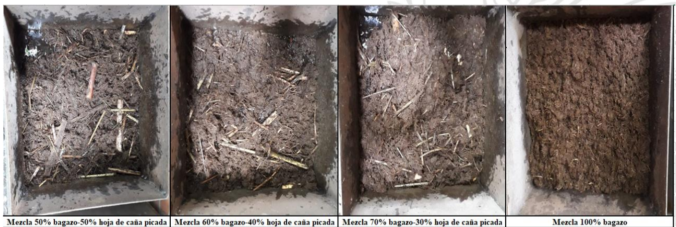
Figura 4. Mezclas bagazo-hoja de caña picada, sobresaturadas.
