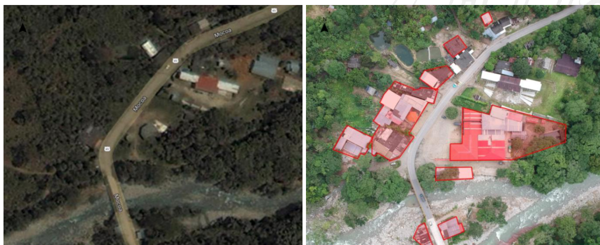
Figura 29: Comparación de imágenes, a la izquierda imagen satelital de 2001 de Google Maps, a la derecha imagen aérea capturada con un dron el 17 de mayo de 2019. En rojo se resalta la nueva infraestructura. Fuente: elaboración propia.
