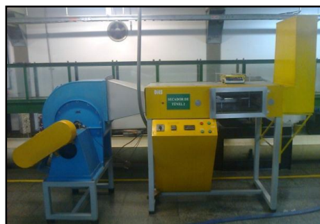
Figura 13. Equipo utilizado para el secado por aire caliente de las rodajas de papa fortificadas.
