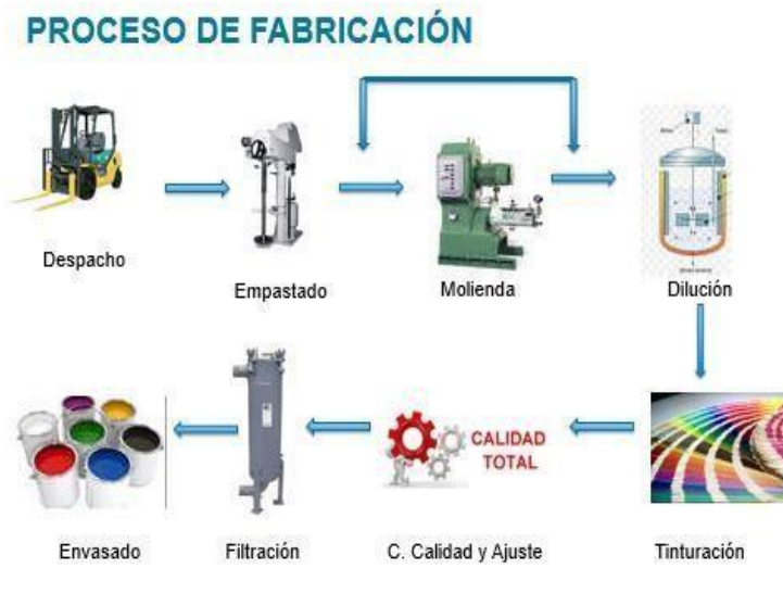
Figura 6. Proceso de producción de pintura en PPG Industries Colombia
