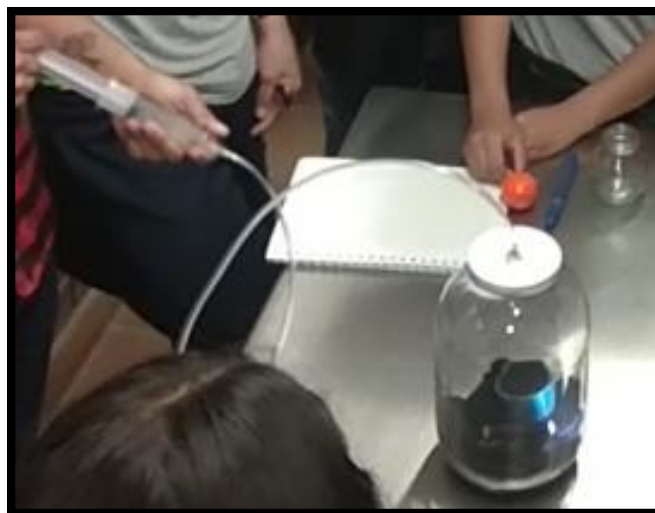
Figura 19: Extracción del aire con la bomba de vacío 37
