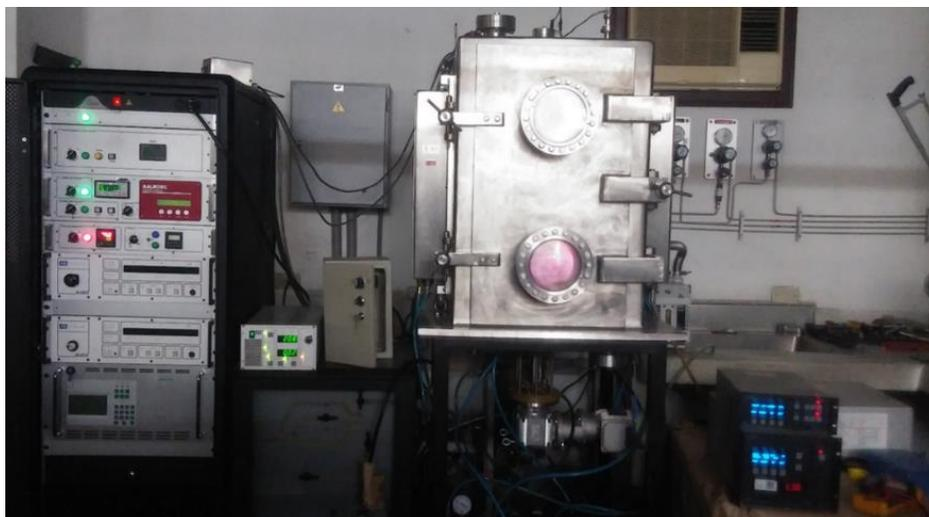
Figura 3. Equipo de pulverización catódica magnetrón de la Universidad de Antioquia.
