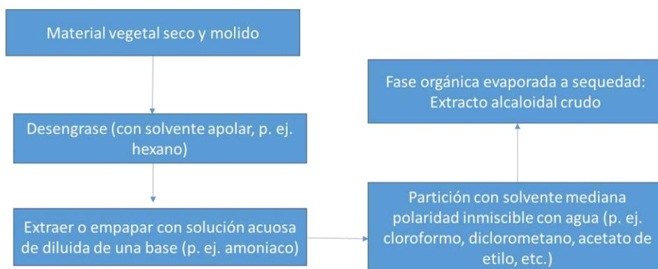
**Figura 4.6.** Diagrama de flujo simplificado para la extracción de alcaloides naturales con soluciones acuosas de bases minerales diluidas.
