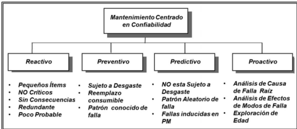
Imagen 2. Clasificación de mantenimiento RCM [6]
