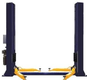
Capacidad de carga 6 toneladas, alimentación a 220 VAC 60 Hz, 2,2 KW, sistema eléctrico hidráulico, altura máxima de elevación 1800mm, altura total 2826 mm, anchura entre columnas 2750 mm, anchura total 3324 mm, peso 610 Kg.
