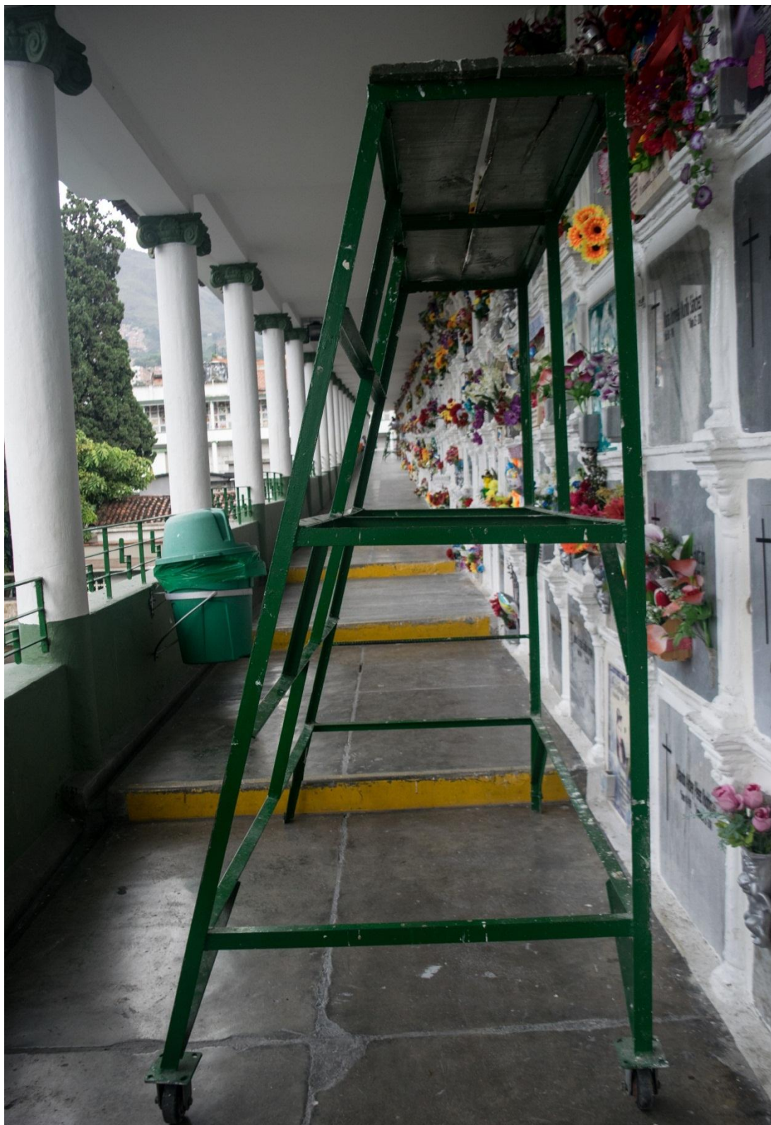
Fotografía 24. Andamio para inhumación, exhumación y mantenimiento de las lapidas. Los Dolores, 2018.
