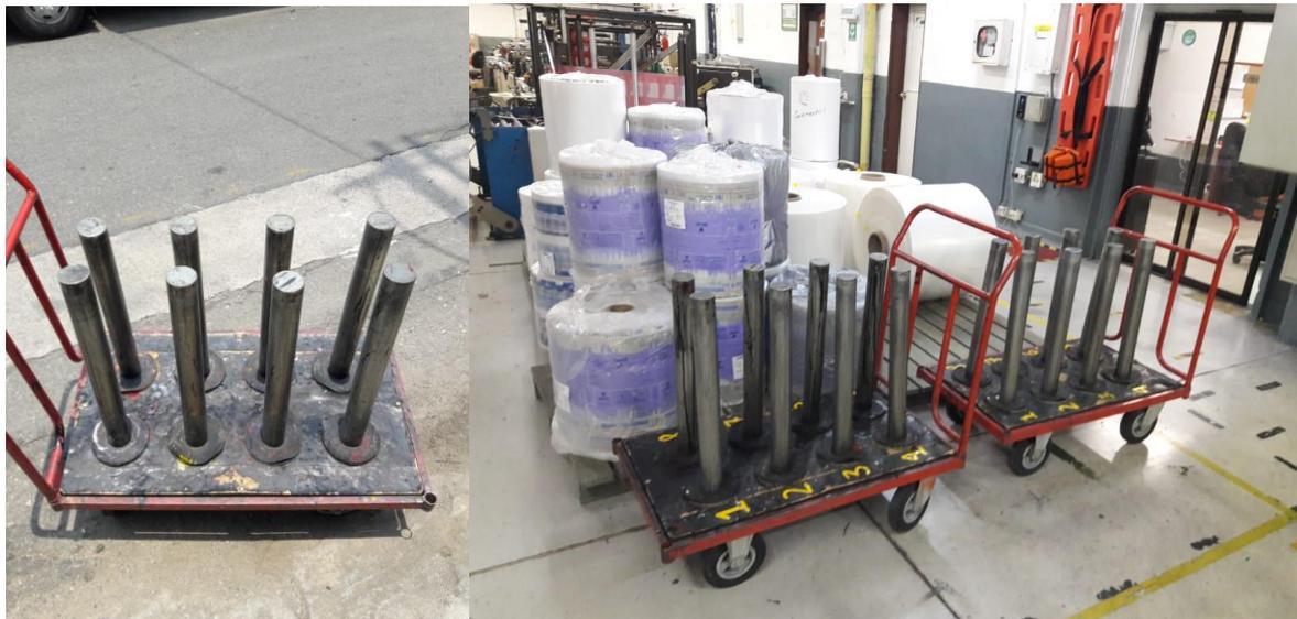
**Figura 26.** Demarcación de carros para la ubicación de mangas y anilox según las unidades en las que serán montados en máquina.
