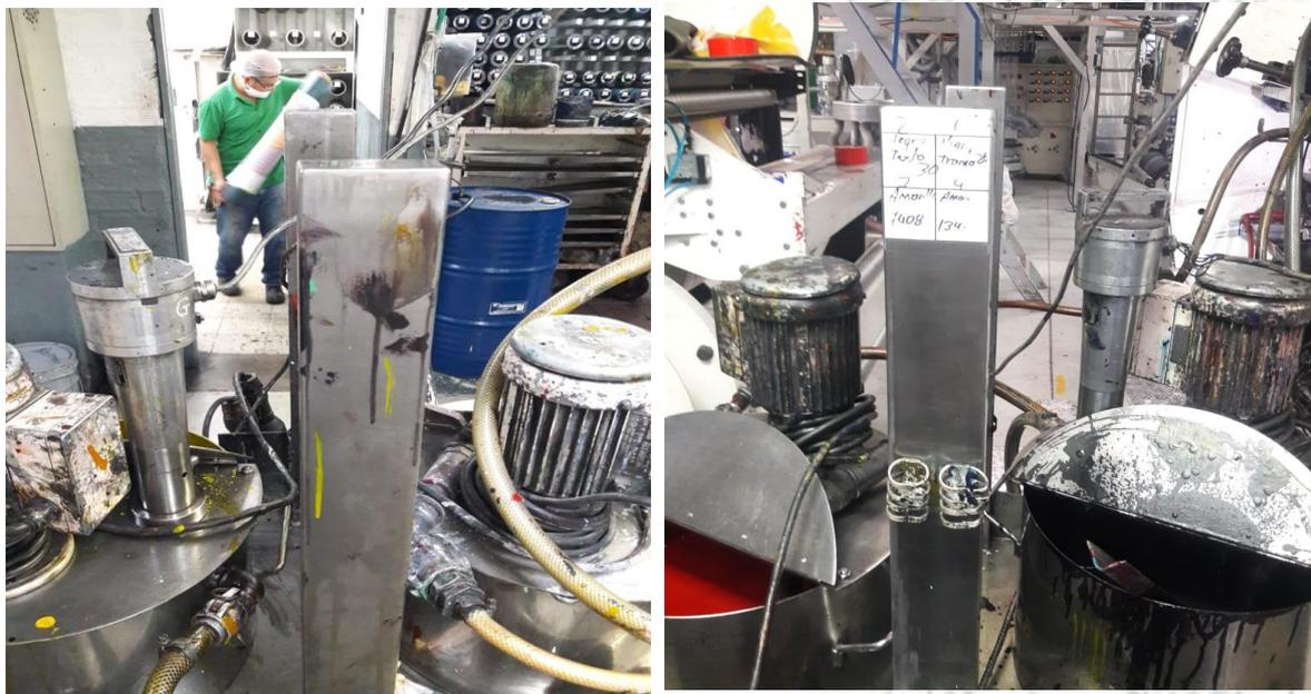
**Figura 27.** Demarcación de ollas para ubicar tintas según las unidades en las que serán montadas en máquina. **Fuente:** Elaboración propia.
