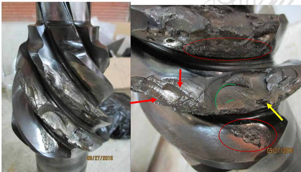
Figura 15. Fractura múltiple del piñón.
