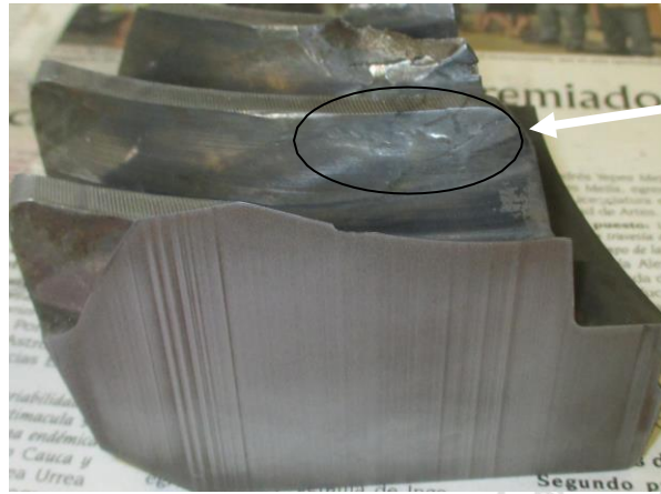
Figura 18. Sección de la corona con diente que no presentó falla.
