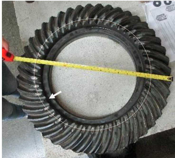
Figura 12. Imagen de corona dentada fracturada en la parte interna de sus dientes.
