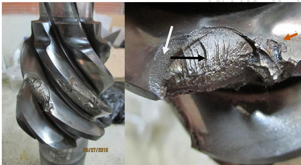
Figura 14. Superficie de fractura del piñón.
