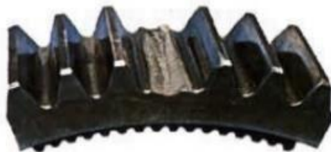
Figura 10. Fractura por impacto [17].
