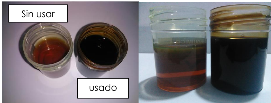
Figura 17. Aspecto visual de una muestra de aceite sin usar y una muestra después de 44.232Km de uso.
