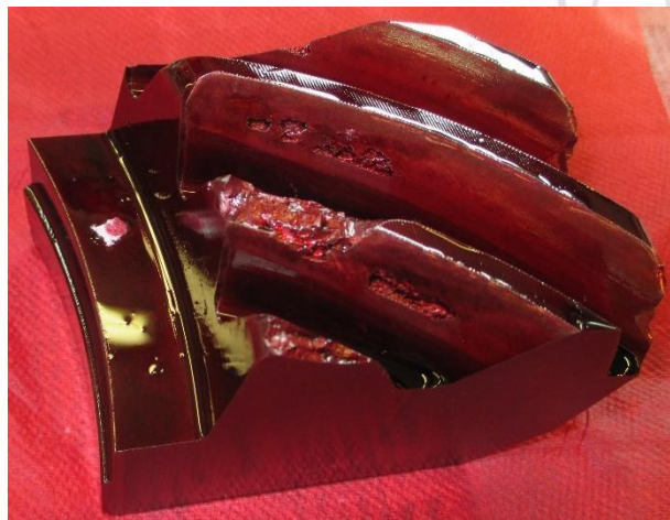
Figura 19. Sección de la corona con líquido penetrante.
