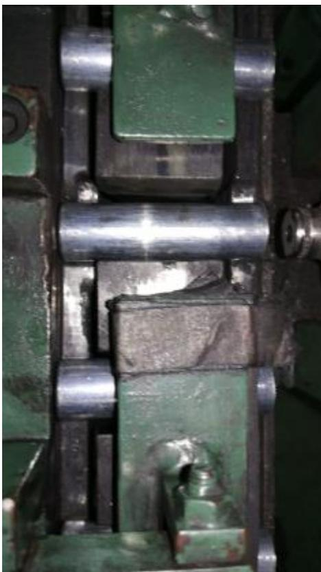
**Figura 18: Desalineamiento de los postizos con respecto a la boquilla de inserción.
