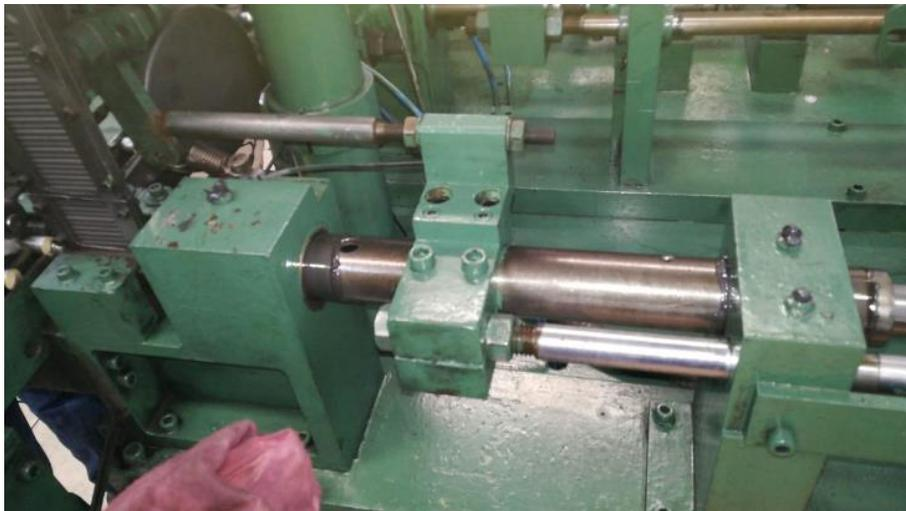
**Figura 15: Alojamientos donde se encuentran los bujes soportes de las barras perforadas.
