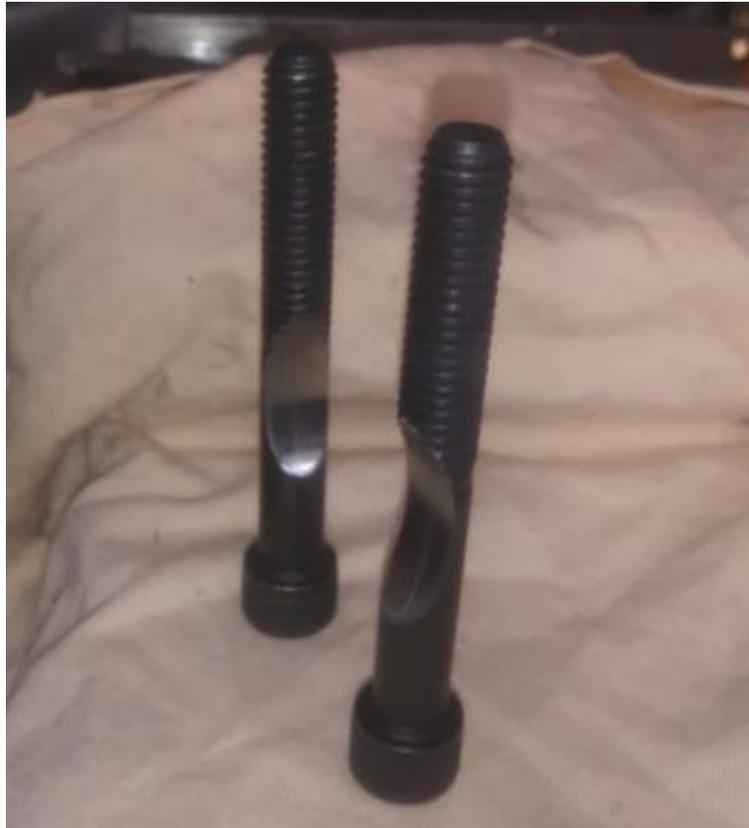
**Figura 6: Tornillos con forma de media luna del sistema de mordazas.
