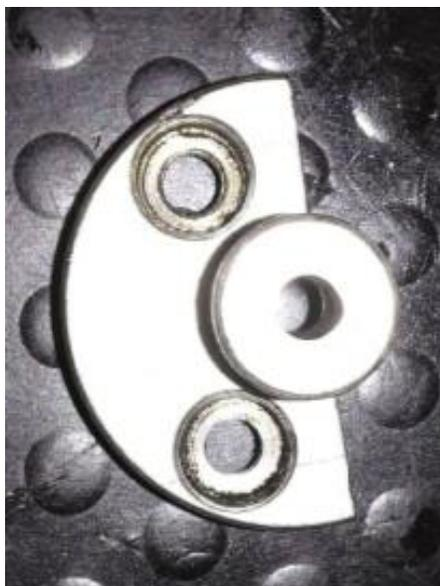
**Figura 7: Desgaste en el diámetro interior de la boquilla de inserción.
