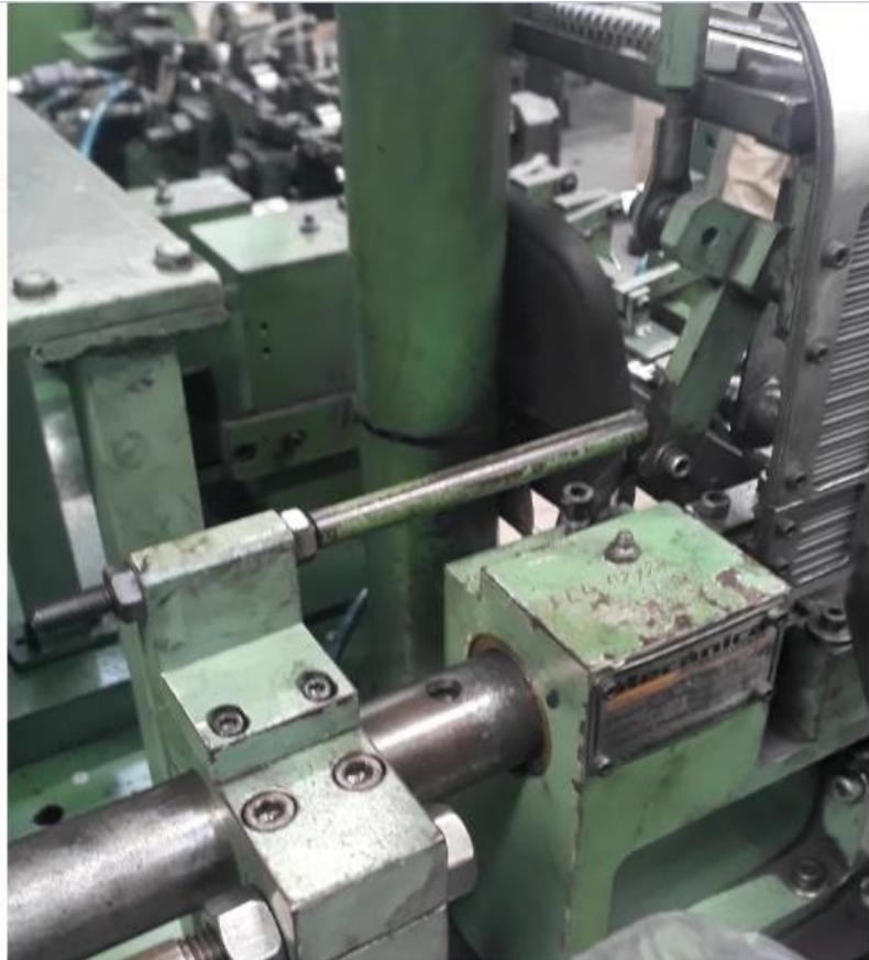
**Figura 3: Barra accionadora de agitadores de carbones.
