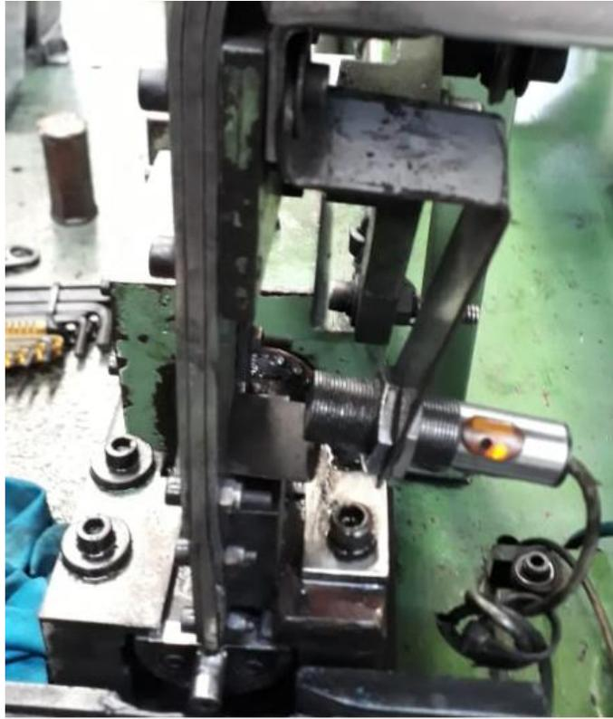
**Figura 4: Sensor capacitivo en el tobogán de carbones de las líneas R6.
