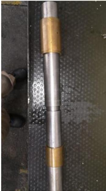
**Figura 16: Bujes de soporte del sistema de inserción.
