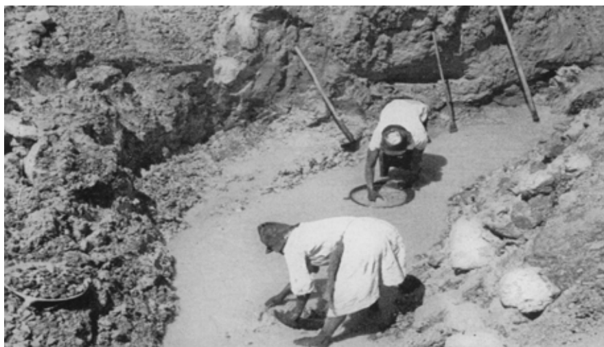
Figura 24. «The cleanup with the batea in a ground sluice within Pleistocene gravels, Antioquian highlands». Tomada de: Robert West, 1952b: 329, figura 7. Obsérvese la altura de las paredes que forman el lugar de trabajo.
