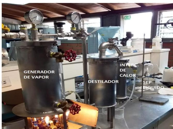
*Figura 12 Montaje en el laboratorio para extracción de aceites esenciales por arrastre con vapor. Equipo del laboratorio SIDCOP – Universidad de Antioquia*
