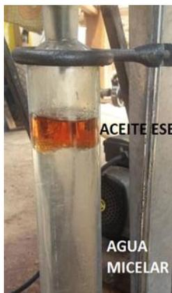
Figura 13 Separador líquido-líquido en laboratorio SIDCOP.
