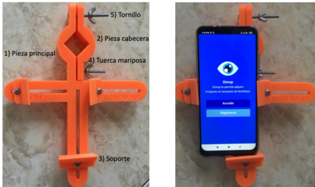
Figura 20. Acople 3D impreso y colocación del celular.
