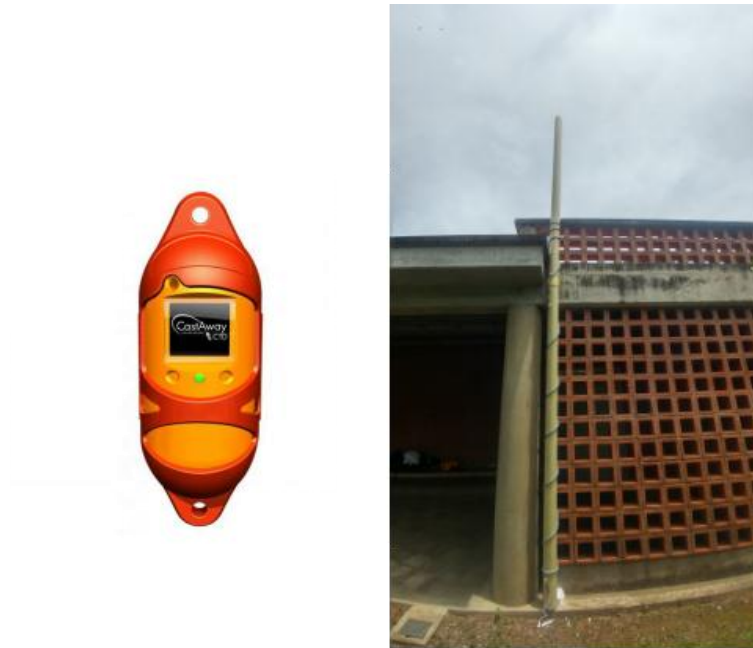
Figura 5. Prueba en “seco” con un CTD CastAway (izquierda) el prototipo y su cadena de sensores. Experimento realizado en columna de agua contenida en tubería PVC a temperatura semi controlada (derecha). Fuente (CTD): fondriest.com/ysi-castaway-ctd.htm
