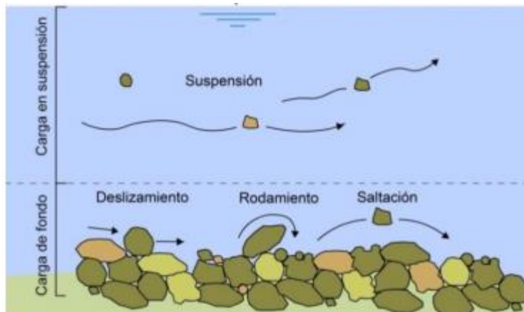
Figura 7: Modos de transporte de los sedimentos.
