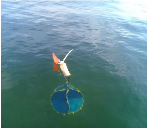
Figura 9: Derivador utilizado en campo durante la época húmeda en playa La Martina.
