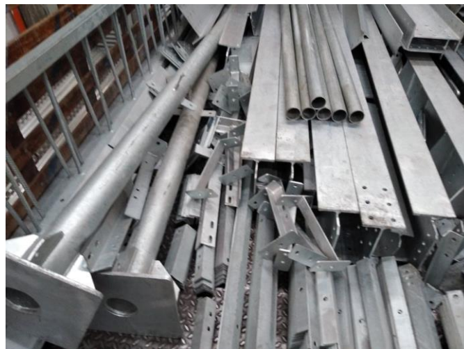
Imagen 21 Perfiles metálicos usados en la empresa INSTALCOM S.A.S para la instalación de estructuras metálicas asignadas a la empresa.
