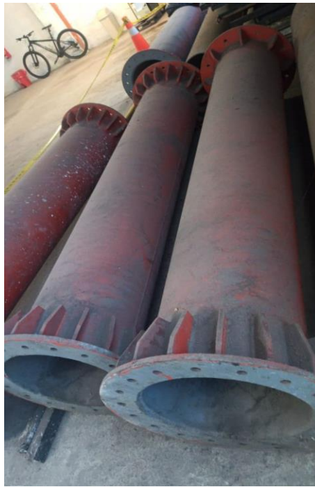
Imagen 20 Elementos estructurales de monopolos listos para instalación fabricados en la empresa INSTLACOM S.A.S
