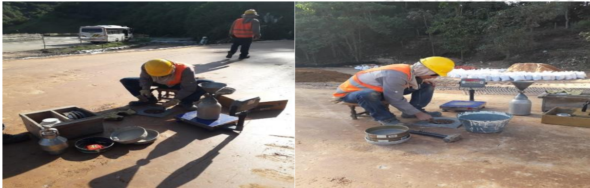
Imagen 12 Toma de densidades por medio del cono de arena
