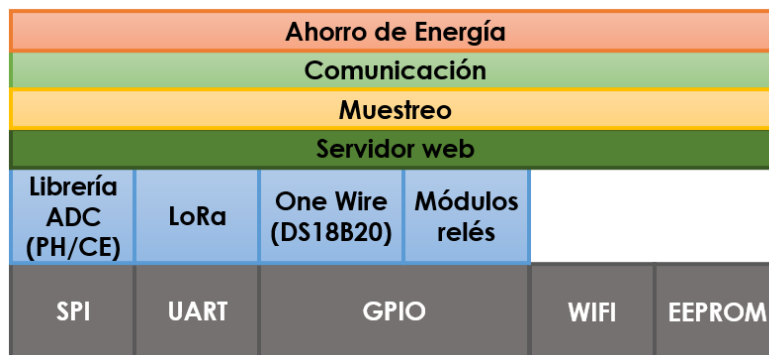
Figura 14. Estructura del software para el nodo agua
