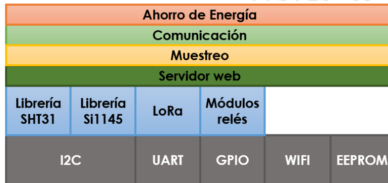
Figura 13. Estructura del software para el nodo ambiente.
