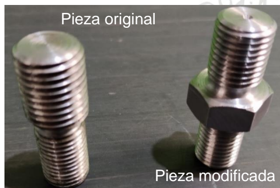
Figura 16. Modificación diseño de mechas.
