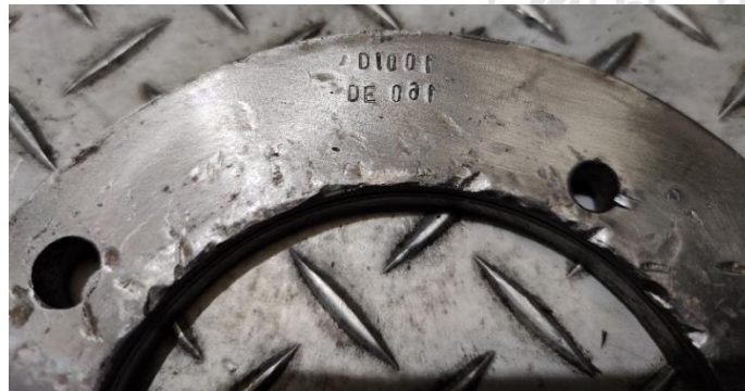
Figura 18. Marcación de anillos centradores.
