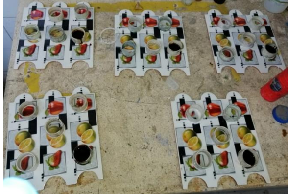
Figura 20. LÍstello redondo sometido a las soluciones descritas en la norma norma NTC 4321-14.
