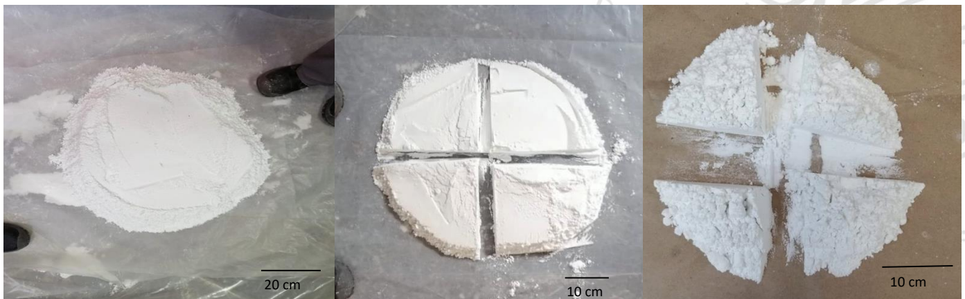
Figura 7. Procedimiento de cono y cuarteo del vidrio molido a nivel semi-industrial.
