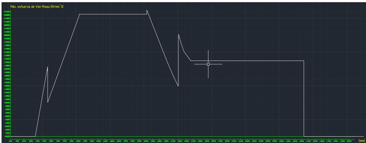
Ilustración 13. Esfuerzo de Von Mises en el eje. Caso 1: Cabina arriba - contrapesa abajo
