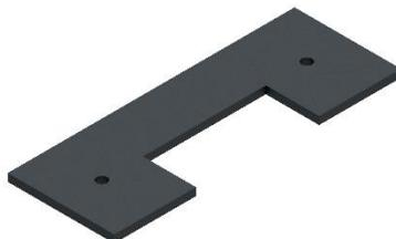
La forma de la contrapesa está conformada por láminas de 3/8 cortadas en forma de C.
