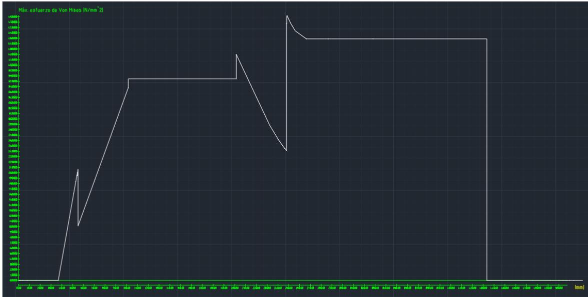
Ilustración 15. Esfuerzo de Von Mises en el eje. Caso 2: Cabina abajo - contrapesa arriba
