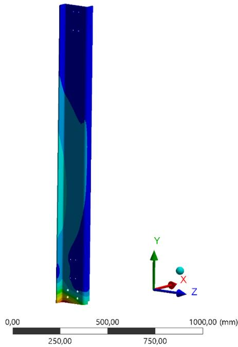
*Ilustración 69. Desplazamiento del perfil vertical de la cabina.*
