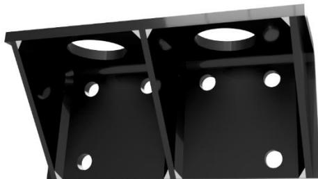
El soporte anclaje cabina – cadena es una pieza compuesta por una lámina doblada de acero A36 laminada en caliente de calibre 5/16”, soldada a tres pie-amigo de calibre 3/16” del mismo acero, se diseñó con ayuda del programa Ansys, estableciendo como soportes fijos los seis agujeros y estableciendo una fuerza de 6000 N, 3000N en cada agujero donde se apoya el resorte como se muestra en la ilustración 17.
