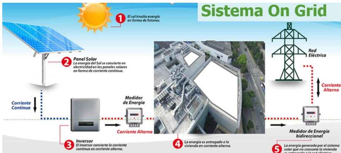
**Figura 9.** Proceso del sistema On Grid usado en el proyecto.
