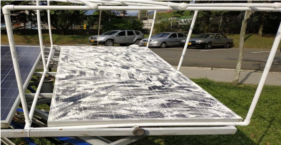
*Figura 10. Emulando material particulado sobre el panel*
