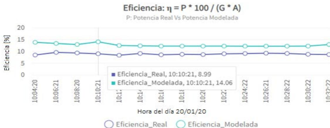
Figura 48. Panel PV registrando baja eficiencia gráficamente
