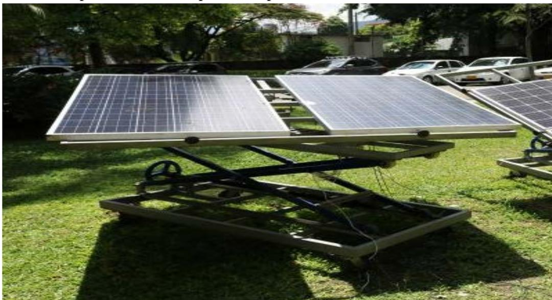
*Figura 7. Panel PV completamente limpio y sin alteración*
