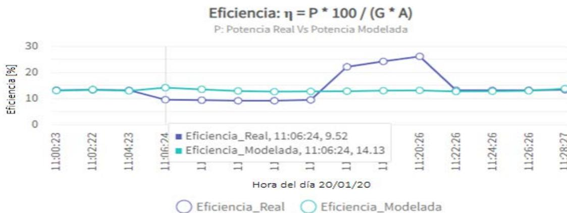
**Figura 49.** Cambios de eficiencia momentáneos sobre el Panel PV de forma gráfica
