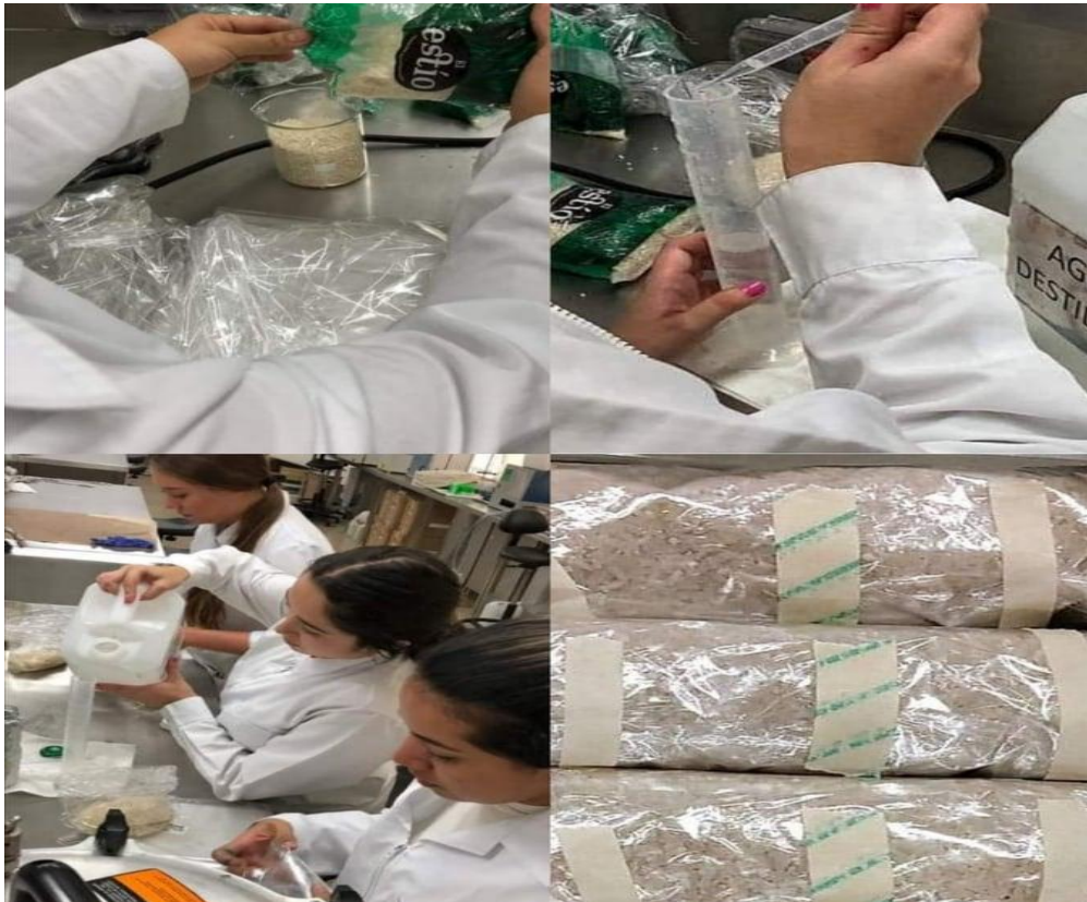
Fotografía 5: Se incorpora el arroz, el agua destilada y el ácido láctico en las bolsas de polipropileno, se sellan con cinta y se llevan al autoclave.
