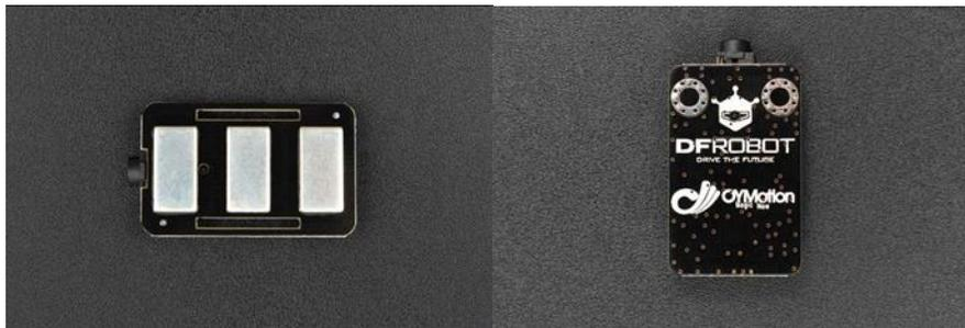
Figura 2. Sensor EMG de OYMotion. Izquierda: Sensor electromiográfico no invasivo. Derecha: Amplificador de instrumentación y filtrado analógico de la señal [7].
