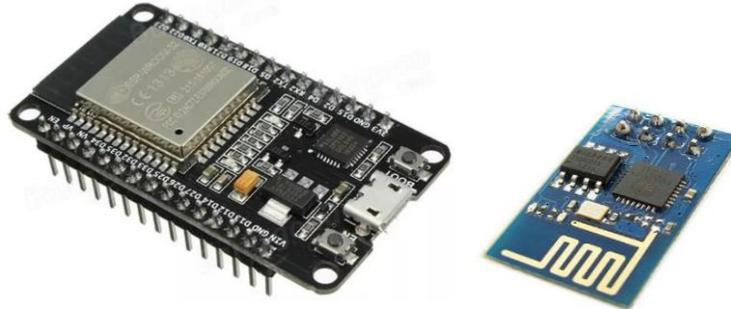
Figura 13. Dispositivos SoC elegidos para comunicación inalámbrica. Izquierda: ESP32-WROOM-32 Derecha: ESP8266.
