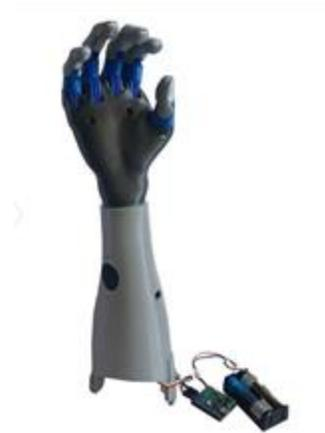
Figura 1. Fotografía del “Robotic Arm v2”, se muestra el brazo mecánico, el circuito de control y la alimentación por batería de litio [6].
