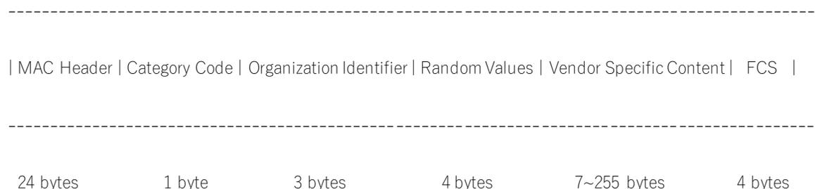
Figura 14. Formato de encapsulación de datos del protocolo de comunicación ESP-NOW. [24]
